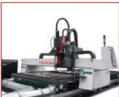
dal materiale grezzo e arriva al pezzo finito: esegue tutti i processi di taglio e marcatura in un'unica operazione, riducendo in maniera importante i costi di movimentazione del materiale. Le Serie HP e SP lavorano lamiere di diverse dimensioni e spessori (fino a 80 mm con plasma e fino a 150 mm con ossitaglio) in base alla larghezza e lunghezza del piano di lavoro.
