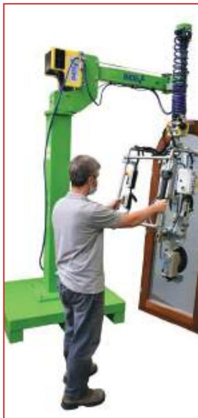
Questo manipolatore presenta tutti i vantaggi di un INDEVA®, ovvero: controllo elettronico che consente rilevazione e bilanciamento automatico e in tempo reale del peso del carico afferrato, compattezza degli attrezzi di presa, movimenti fluidi e precisi, nonché sistemi di sicurezza contro la caduta accidentale del carico e che impediscono movimenti incontrollati rischiosi per l'operatore.
