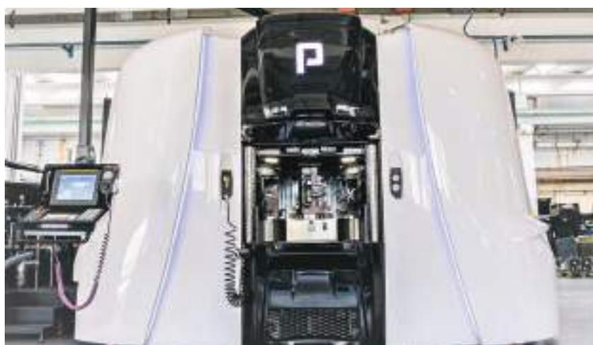
di quattro pallet in continuo (tre in lavorazione, uno di carico/scarico), tre centri di lavoro orizzontali con movimento X, Y, Z, cambi di produzione in 15 min,
