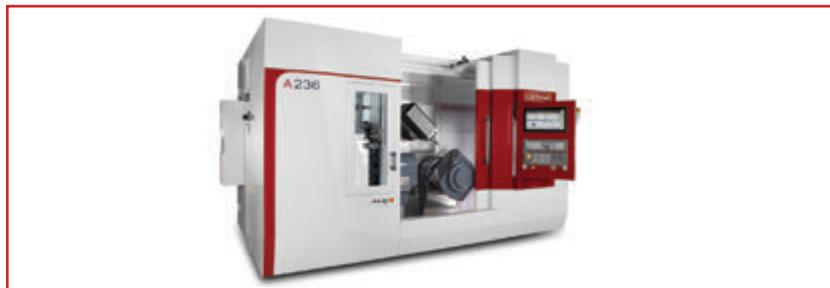
versione a 5 assi è prevista sia una versione con assi continui a trasmissione meccanica, sia la versione più evoluta con assi Torque. In queste configurazioni la tavola girevole ha una piattaforma di diametro 630 mm, annegata in una semitavola sagomata con dimensioni 700 x 700 mm, in modo che il piano di lavoro sia perfettamente sullo stesso piano. In questo modo è possibile eseguire facilmente lavorazioni
