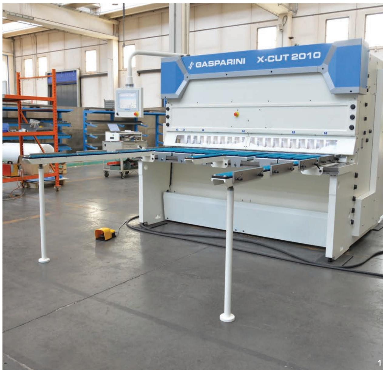
La toscana Bandinelli & Forni Metalli ha scelto di investire su una cesoia a ghigliottina X-Cut 2010 di Gasparini in modo da garantire tagli di precisione, preservando al tempo stesso la superficie e ottenendo pezzi perfetti senza deformazioni.
