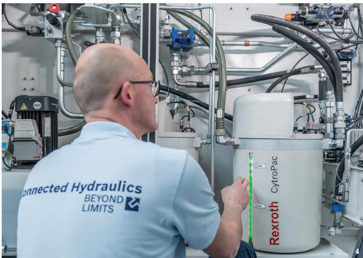
pressioni differenti, la centralina Rexroth viene utilizzata al massimo del suo potenziale solo quando realmente necessario: una volta che l'utensile viene scaricato, CytroPac torna a lavorare alla pressione standard di 50 bar, sufficiente per la gestione dei sistemi frenanti. In questo modo, la centralina idraulica CytroPac, oltre a una sostanziale riduzione del rumore e a un significativo
