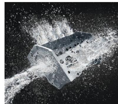
prolungata, è anche progettato per assicurare elevati livelli di compatibilità con i fluidi da taglio Castrol Alusol e Hysol XBB. Questo significa che, invece di dover essere smaltito al termine della vita utile di pulizia, può essere riciclato nell'impianto del fluido da taglio senza compromettere le prestazioni. In questo modo, è possibile limitare il consumo d'acqua e ridurre, o addirittura eliminare completamente, i costi di smaltimento del lavante.
