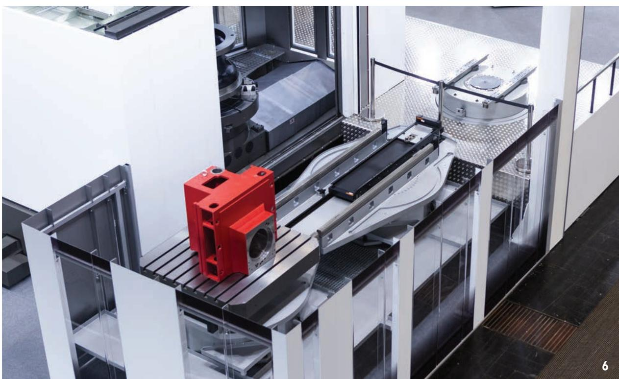
ma che consente anche di eseguire operazioni di tornitura. Dispone di un asse di rotazione continua a 45° con un sistema a doppio pignone e raggiunge un regime massimo di rotazione del mandrino pari a 8.000 giri/min. Sostituendo automaticamente l'accessorio per la tornitura, la testa è in grado di svolgere operazioni di tornitura impegnative grazie alla sua elevata robustezza.
