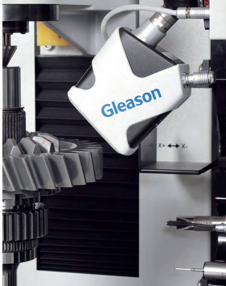
● L'area di lavoro dell'apparecchio di controllo 300GMSL di Gleason Corporation. ● The operating area of 300GMSL Multi-Sensor Gear Inspection System from Gleason Corporation.
