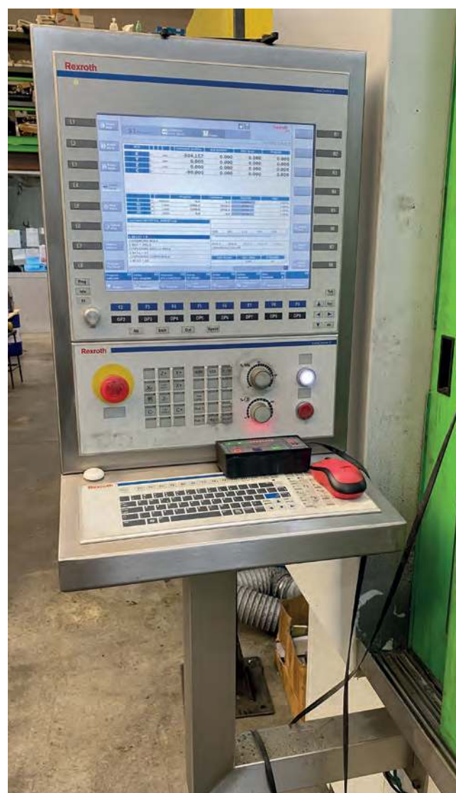
● Il CN, accoppiato ai motori lineari, entrambi di Bosch Rexroth, controlla la rettificatrice Gitex. ● The NC, coupled to linear motors, both from Bosch Rexroth, controls Gitex grinding machine,
