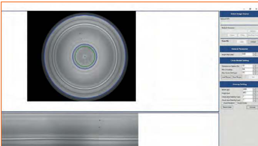
● Figura 4. Tappo per sacche per terapia endovenosa ispezionato con un'ottica con vista a 360° per l'ispezione di fori e cavità. ● Figure 4. IV therapy bag caps inspected with 360° view optics designed for the inspection of holes and cavities.
