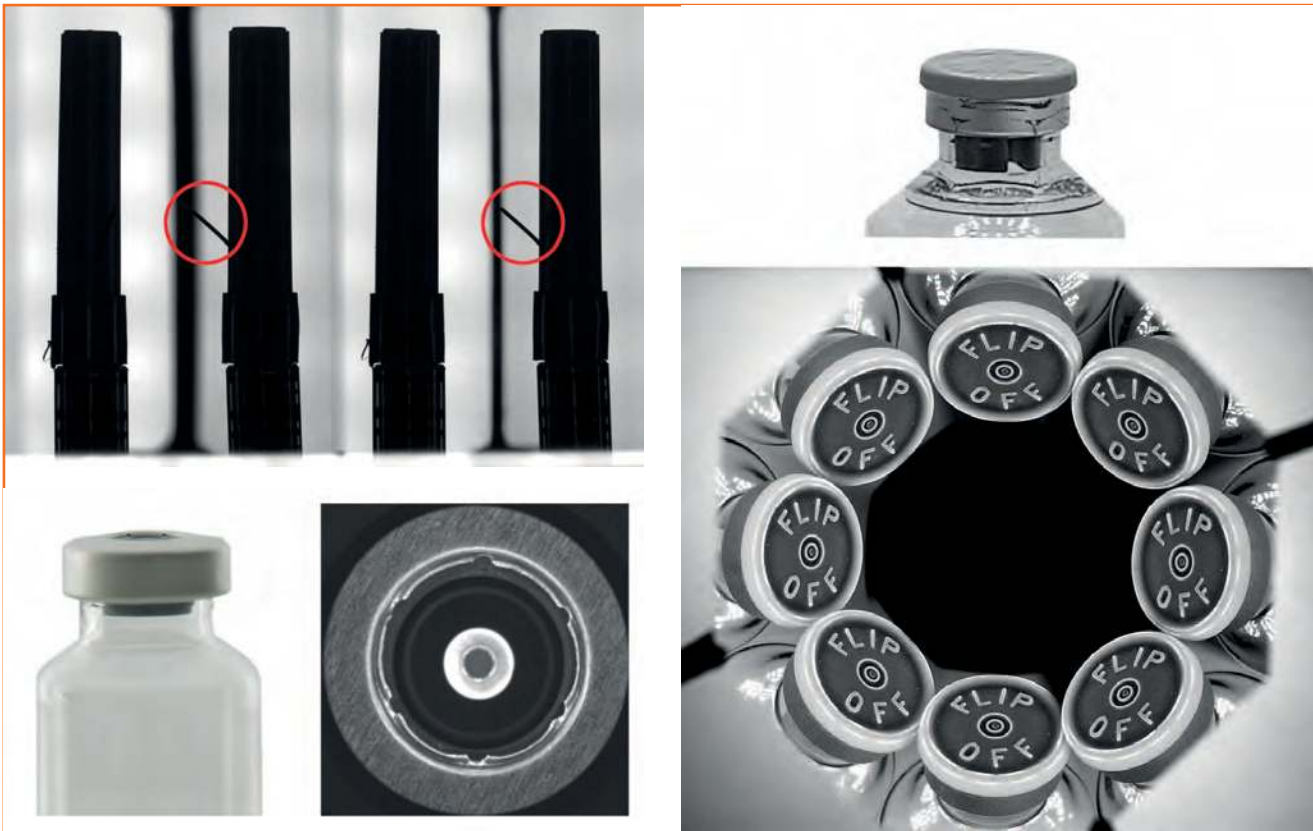
● Figura 3. Tappi di protezione per siringhe e contenitori farmaceutici ispezionati con ottiche con vista a 360°.
