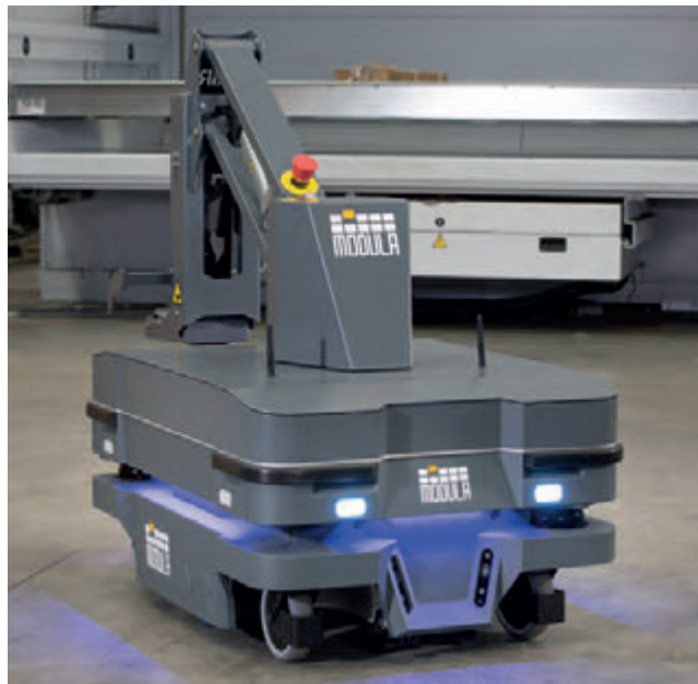
● Il robot MiR, dotato di modulo top dedicato in grado di prelevare e depositare i cassetti contenenti il materiale. ● The MiR robot, equipped with a special top module designed to handle the trays.
