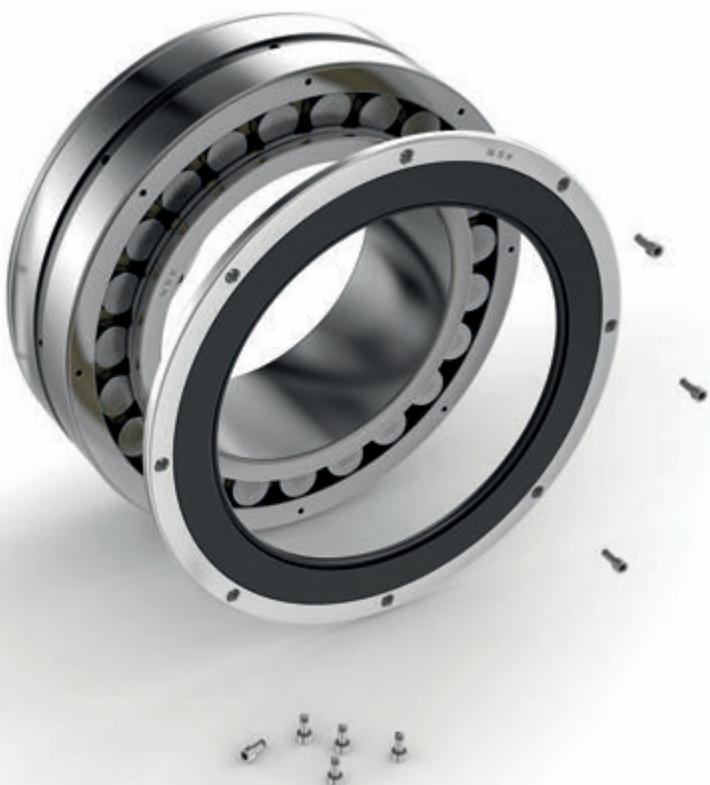
● La tenuta è applicata su un anello/supporto completamente rimovibile (mediante bulloni), per consentire di accedere e misurare il gioco con appositi spessimetri.
