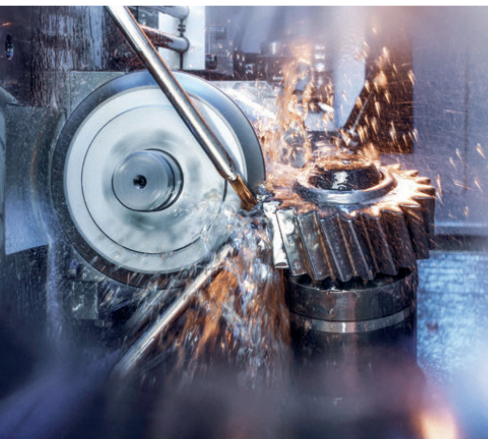
● Figura 1. Esempio di rettifica di un ingranaggio epicoidale ipoide, sempre più diffuso nelle trasmissioni EV.
