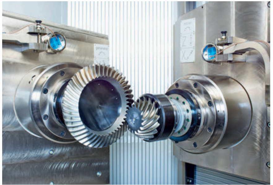
● Fig. 1: Banco prova automatizzato per ingranaggi conici.
