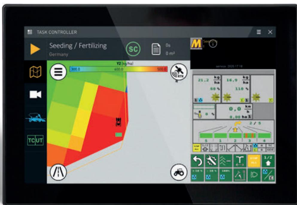
Il software di Parker Hannifin ISOBUS Suite verrà implementato sui veicoli agricoli nella sua versione completa ISOBUS Task Controller (TC), che comprende le applicazioni per ISOBUS UT e ISOBUS TC, insieme al Pro Display HMI. Grazie a questo strumento, l'attività agricola verrà ottimizzata e resa più precisa, così da ridurre costi e tempi di lavoro.
