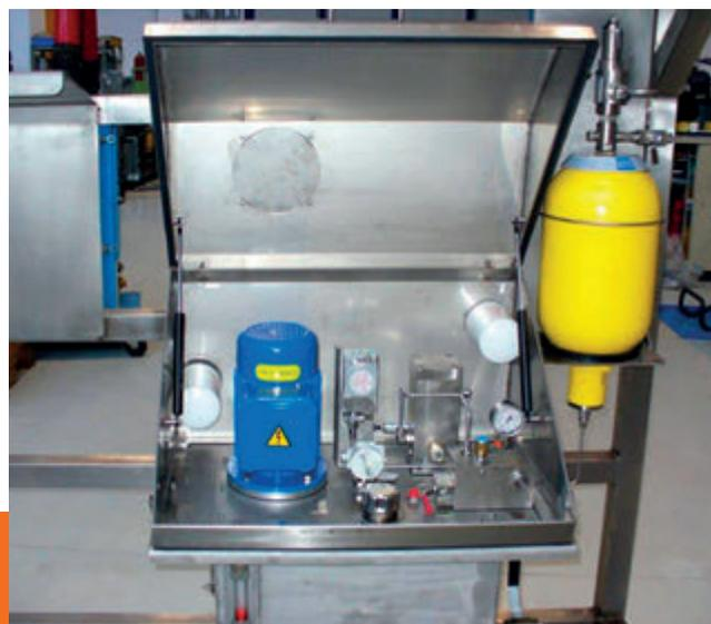
Le condizioni climatiche estreme, con temperature di -40°C hanno imposto una riprogettazione dei componenti principali di “fail safe”. La condizione di fail safe è gestita da elettrovalvole monostabili in serie che agiscono sul pilotaggio di elementi logici. La portata di fail safe è assicurata da un accumulatore a sacca.
