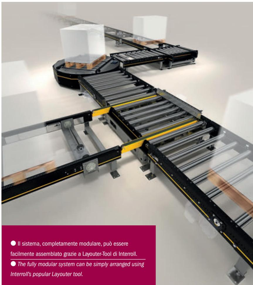
● Il sistema, completamente modulare, può essere facilmente assemblato grazie a Layouter-Tool di Interroll.
