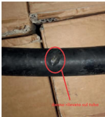
● Il danno rilevato sul tubo flessibile montato nel vano motore dell'autobus.
