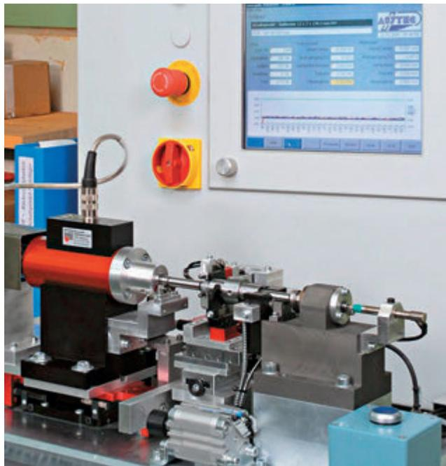
● La vite a passo lungo 'Speedy' converte - a elevate velocità di traslazione - movimenti lineari in movimenti di rotazione. Può essere realizzata parzialmente in alluminio.
