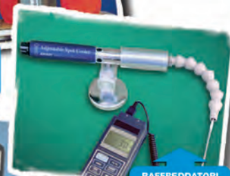
RAFFREDDATORI PER UTENSILI ED ALTRE APPLICAZIONI DOVE È NECESSARIO DISSIPARE CALORE
