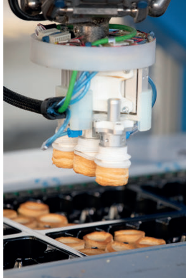
Un organo di presa con tre ventose con movimento verticale indipendente, consente di prelevare e depositare all'interno dei relativi termoformati tre prodotti in contemporanea.
