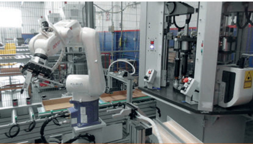
Il robot preleva dal sistema di alimentazione a vibrazione la cartuccia filtro per il miscelatore e la posiziona di fronte a un sistema di visione.
