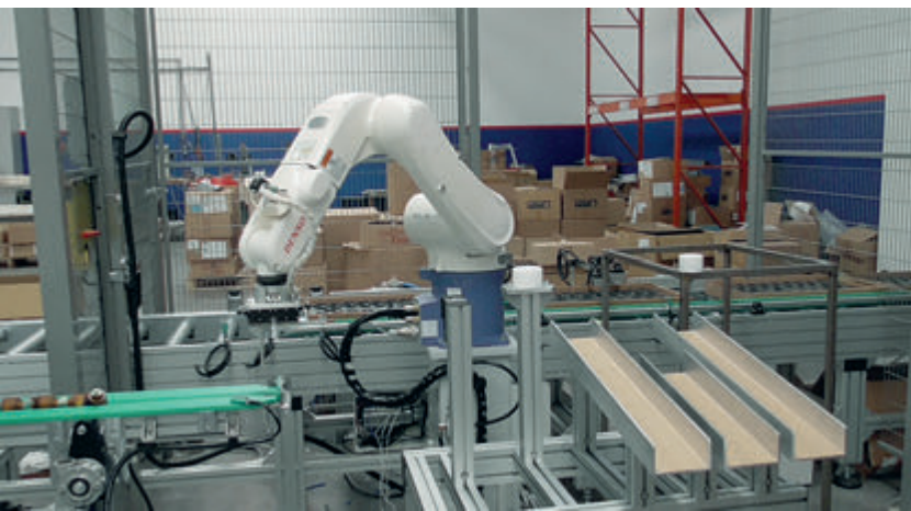
Per questa applicazione è stato scelto un robot della gamma DENSO VS6577, con sbraccio da 854 mm e payload di 7 kg.
