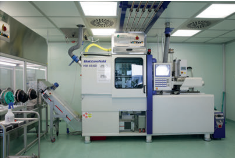
Per realizzare componenti con il polimero PLLA è necessario l'utilizzo di una macchina per lo stampaggio a iniezione.
