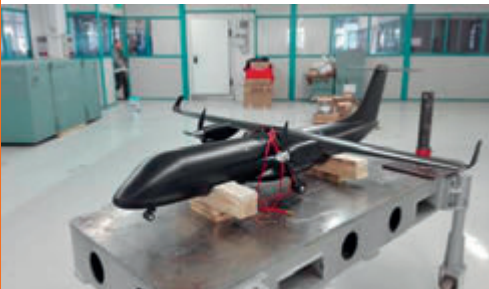
Rappresentazione 3D e realizzazione di un modello in scala (1:18) della galleria del vento del progetto Scavir.
