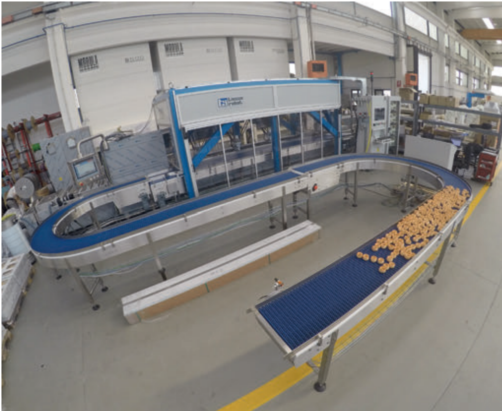
La linea robotizzata realizzata da Tiesse Robot per il confezionamento dei vol-au-vent.
