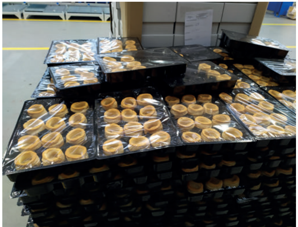
La linea permette di confezionare all'interno di blister con configurazione delle nicchie di contenimento variabili termoformati, una serie di prodotti con diametro variabile di 38, 50 e 60 mm.
