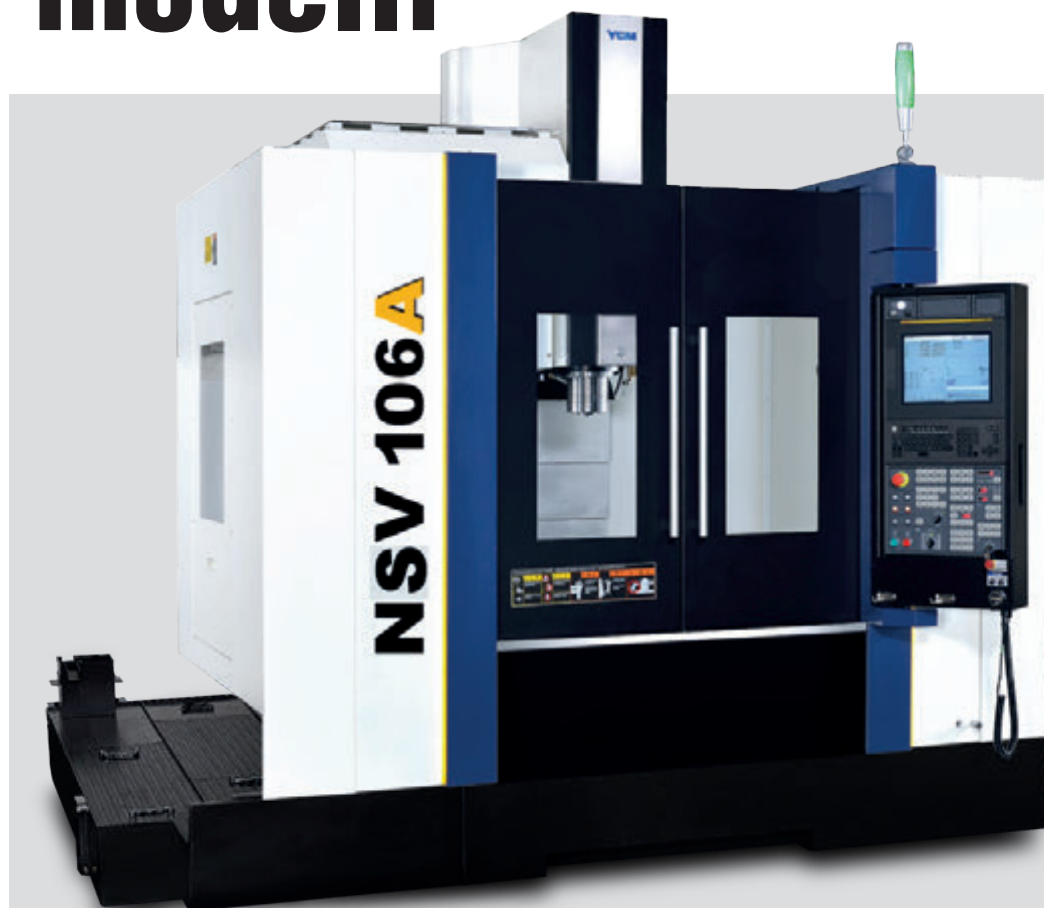
Il centro di lavoro YCM NSV106A ha una struttura a C interamente realizzata in ghisa meehanite, con colonna “a delta” e basamento extra-large.
