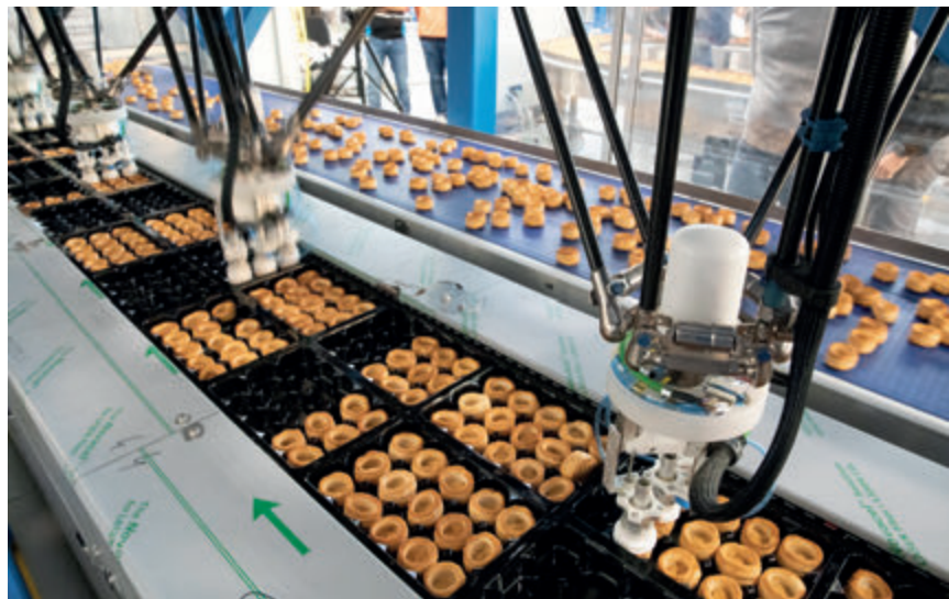
La stazione di packaging vera e propria è sinteticamente composta da una cabina all'interno della quale sono disposti quattro robot Kawasaki a cinematica parallela YF03.
