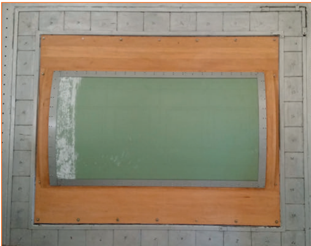
Pannello di fusoliera full scale per prove acustiche realizzato per il progetto FUSIMCO.
