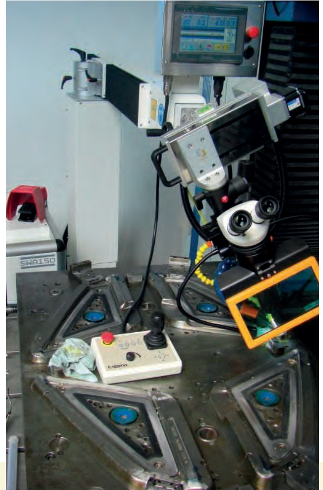
Saldatura con ausilio del joystick. Welding with the help of a joystick.
