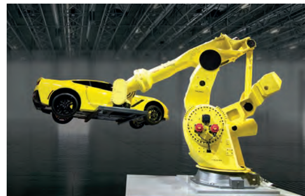
Il sollevatore FANUC M-2000iA/1700L è uno dei robot industriali più forti, con capacità di carico al polso di 1.700 kg.
