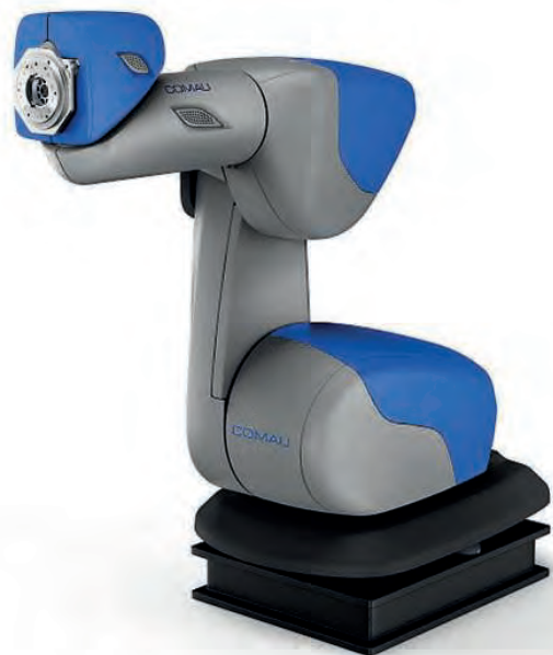
Un robot collaborativo Racer3 AURA di COMAU si occuperà della movimentazione magnetica di una capsula robotica per procedure di colonoscopia indolore.
