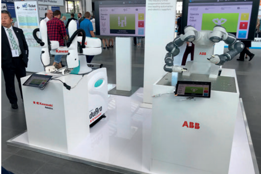
Una demo congiunta presso l'ingresso est di automatica presentava l'esclusivo e innovativo robot SCARA a due bracci di Kawasaki, "duAro", che lavora fianco a fianco con il "collega" YuMI® di ABB.
