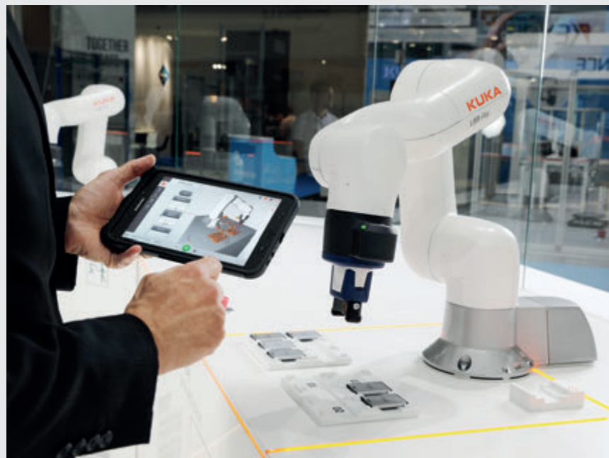
LBR iiisy è progettato specificamente per compiti di manipolazione leggera e assemblaggio con carichi fino a 3 kg.
