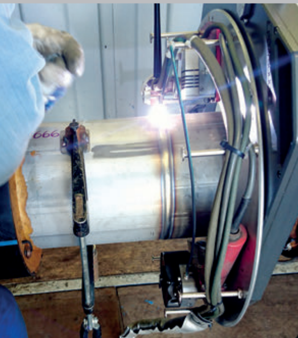
4. Testa di saldatura TIG orbitale in azione con corrente pulsata; durante la fase di alta intensità (corrente pulsata) si ottiene la piena penetrazione.
