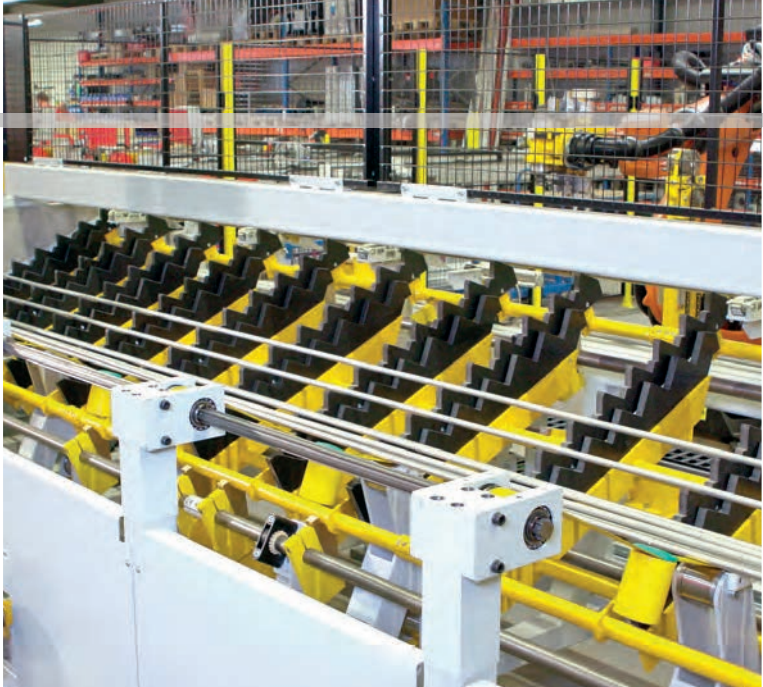
Il magazzino convogliatore a gradini: alimenta i tubi lunghi verso il robot di curvatura.
