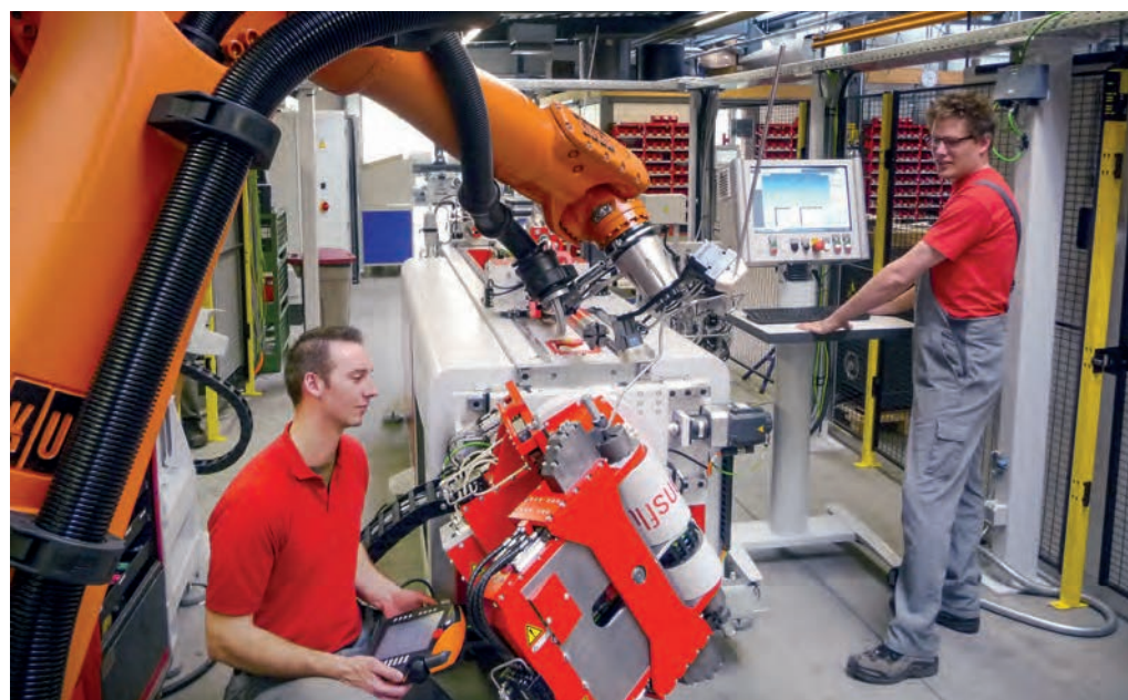
Come per le curvatrici tradizionali, anche i robot di curvatura possono caricare i dati necessari da un file di dati direttamente dal sistema CAD e trasformarli in una geometria di curvatura.
