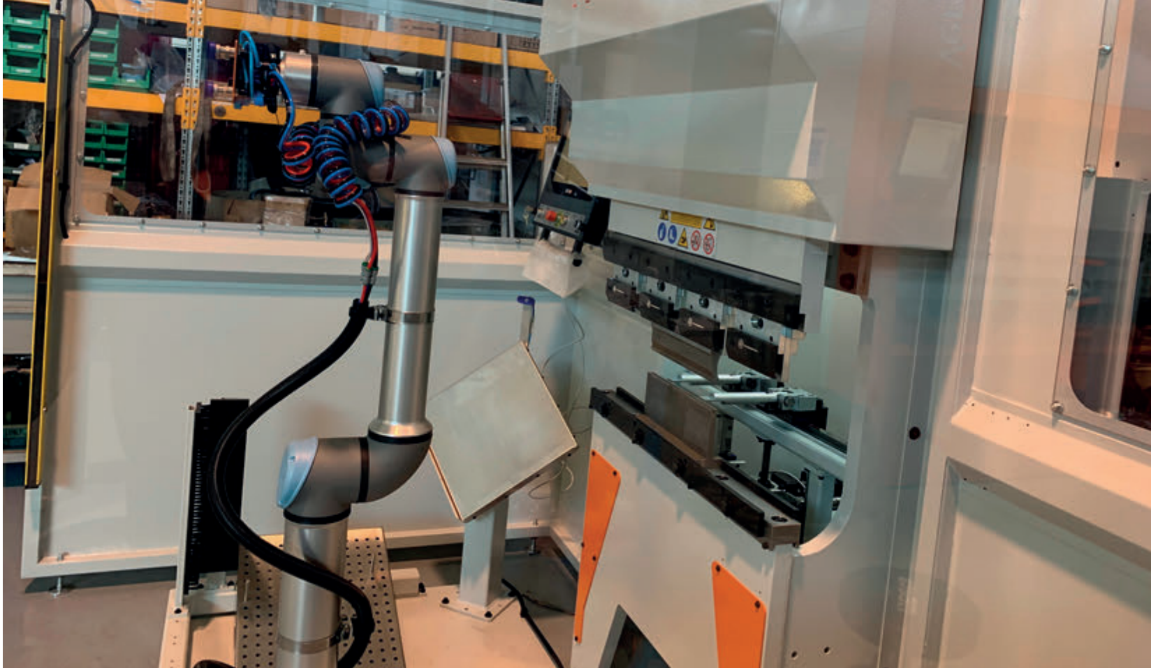
Il cobot della cella è un UR10e con 1300 mm di sbraccio e 12,5 kg di portata al polso.
