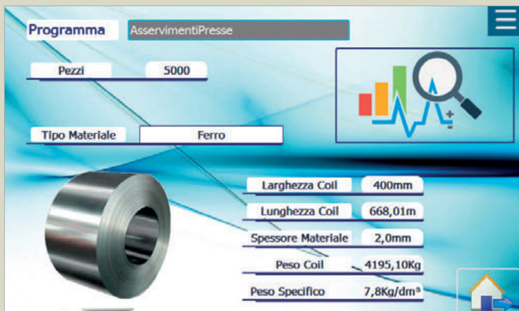
L'app di calcolo coil permette all'operatore di visionare in funzione dei dati inseriti nella ricetta la lunghezza del rotolo, il suo peso e in automatico anche la durata della lavorazione.
