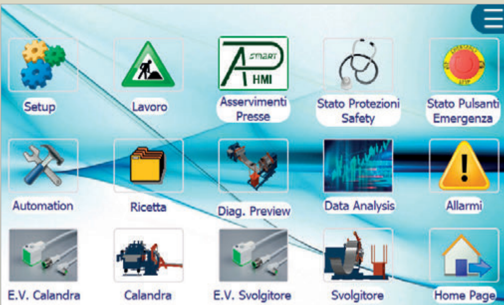
AP Smart HMI è strutturato in app, per regolare al meglio funzioni come manutenzione, calcolo coil, stato dei pulsanti di emergenza, analisi dei dati e diagnostica.
