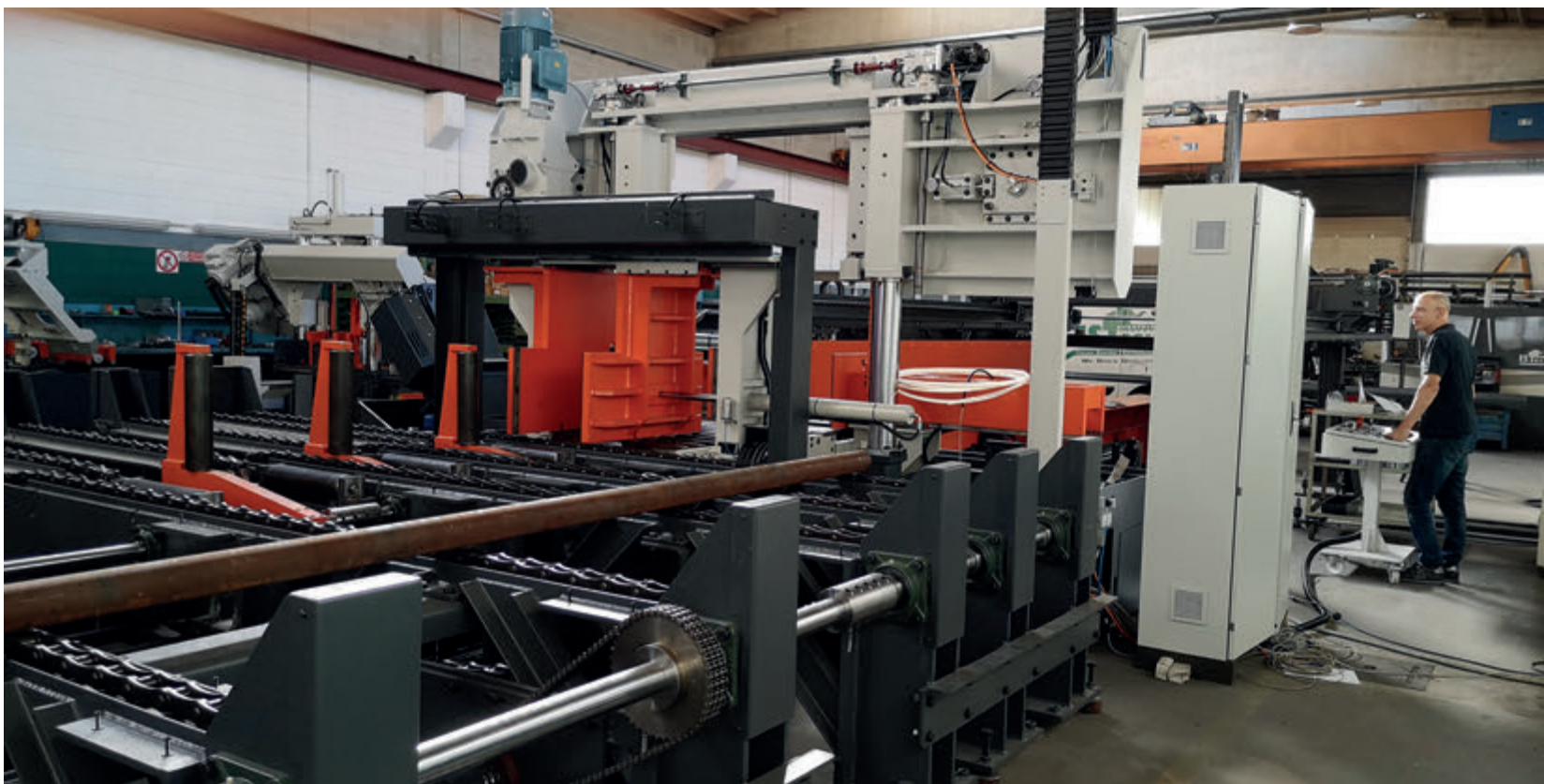
La segatrice è stata pensata per sfruttare al massimo le potenzialità delle lame in metallo duro.
