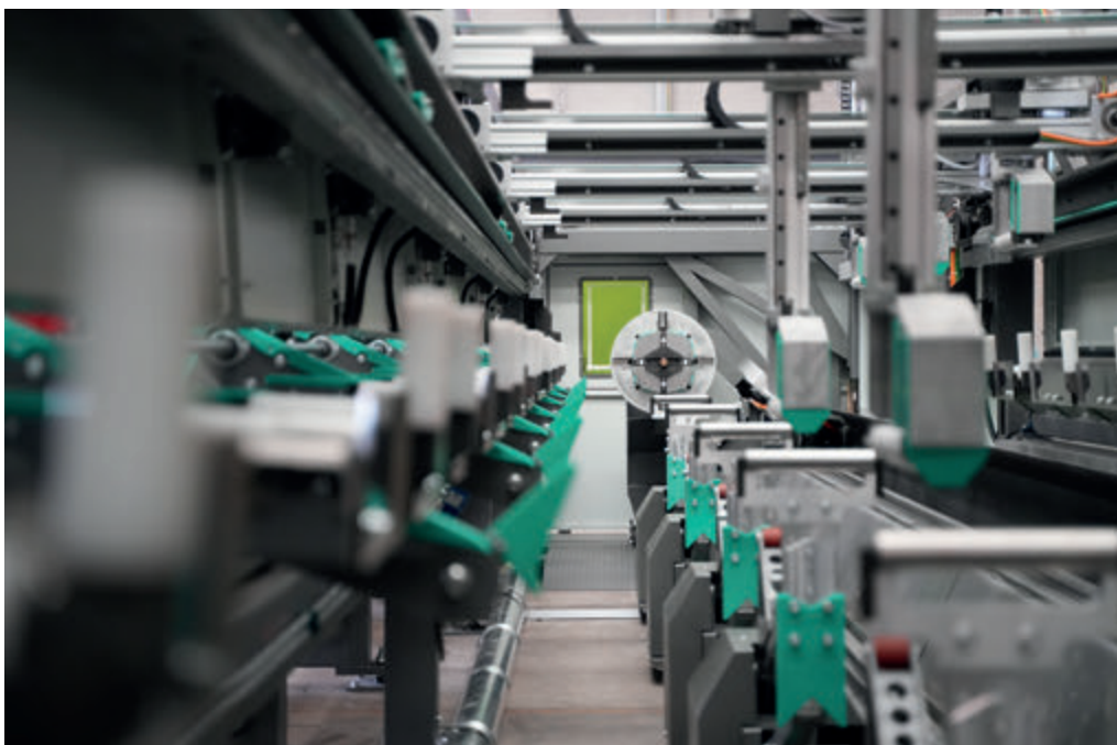
Con la LT 8.20 impiegati presso Morandi Steel ha una lunghezza di carico di 12.000 mm e una di scarico di 8.500 mm.
