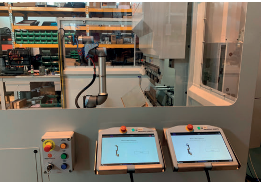
Le celle collaborative RPC rispondono, con efficacia alla richiesta di manipolazione di piccoli pezzi e la variabilità dei lotti produttivi.
