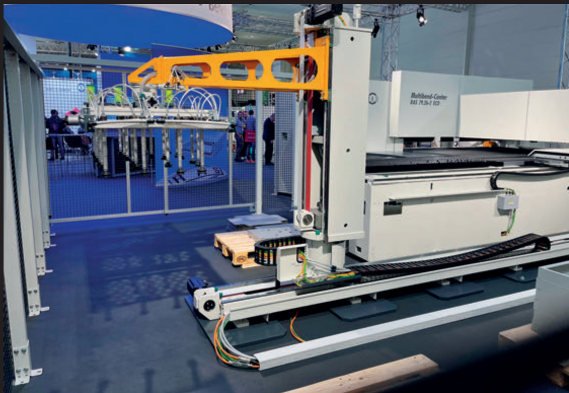
Il nuovo centro di piegatura Multibend-Center ECOauto di RAS è caratterizzato da un robot cartesiano di carico e scarico.
