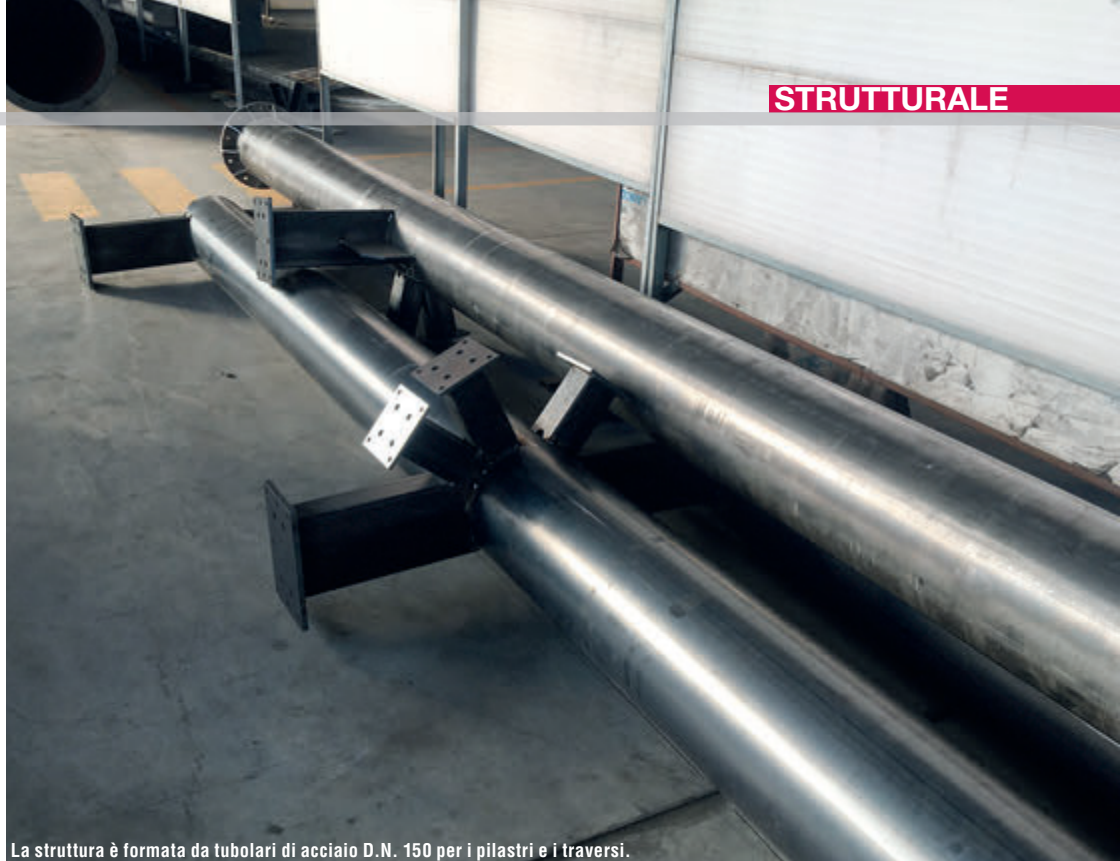
La struttura è formata da tubolari di acciaio D.N. 150 per i pilastri e i traversi.
