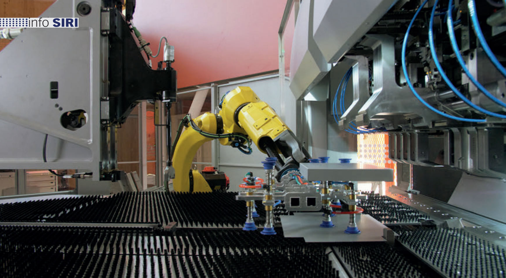
Il robot è equipaggiato con un organo di presa ribaltabile dotato di ventose su due lati che consente di ottimizzare i cicli di carico/scarico della lamiera.
