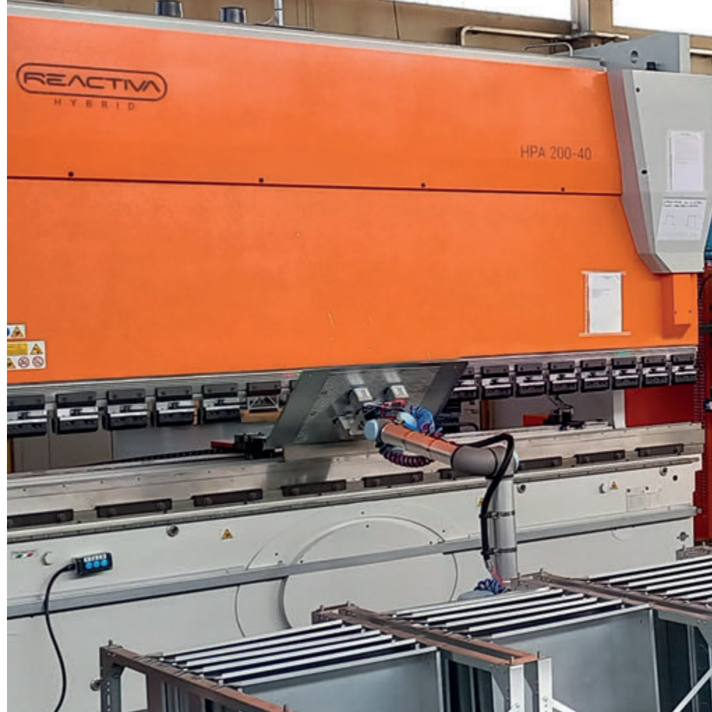
La piegatrice Reactiva HPA 200-40 è stata dotata di cobot Universal Robots dando vita a vera isola di piegatura robotizzata.
