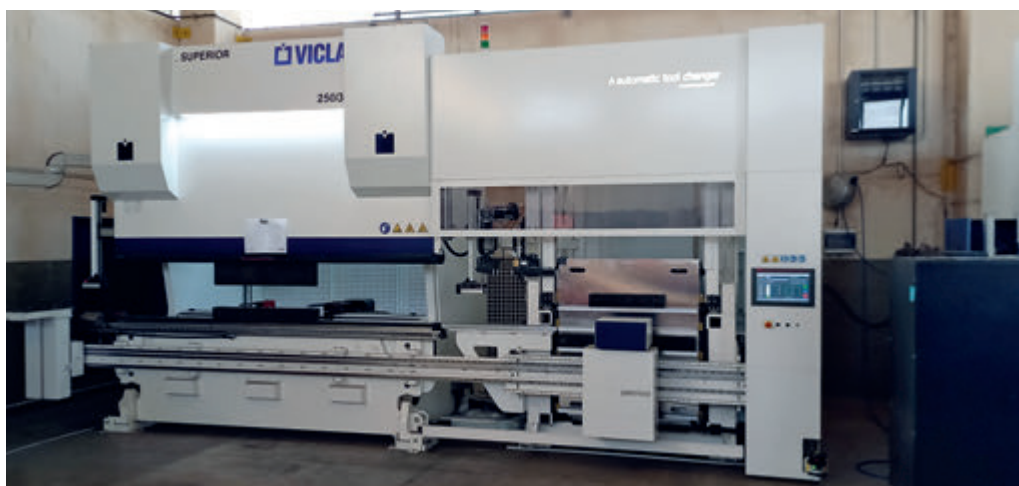
Grazie alla piegatrice .SUPERIOR con magazzino ATC di VICLA, l'azienda ha incrementato la produttività nella piegatura.
