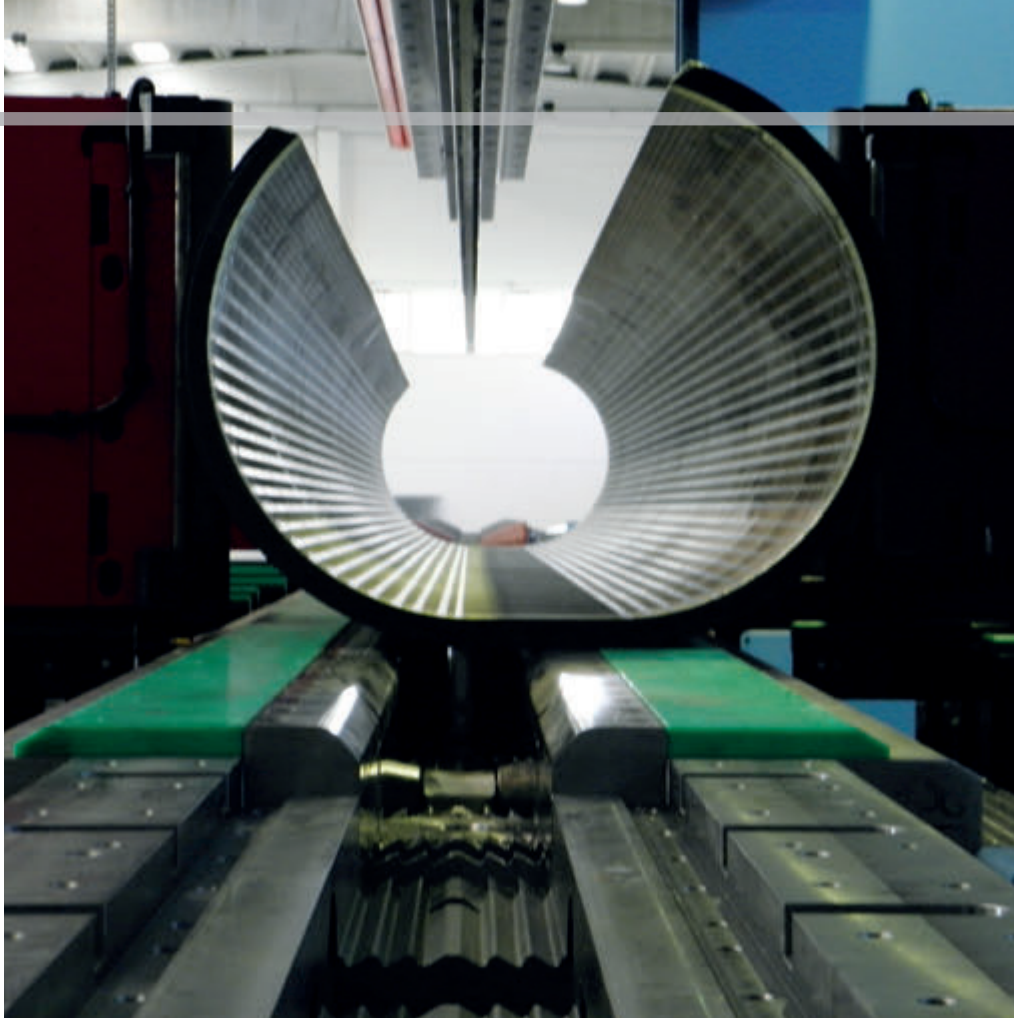
Le presse piegatrici di Colgar Bending Machines possono produrre tubi presso-piegati con diametri sino a 50 pollici e spessore di 100 mm.
