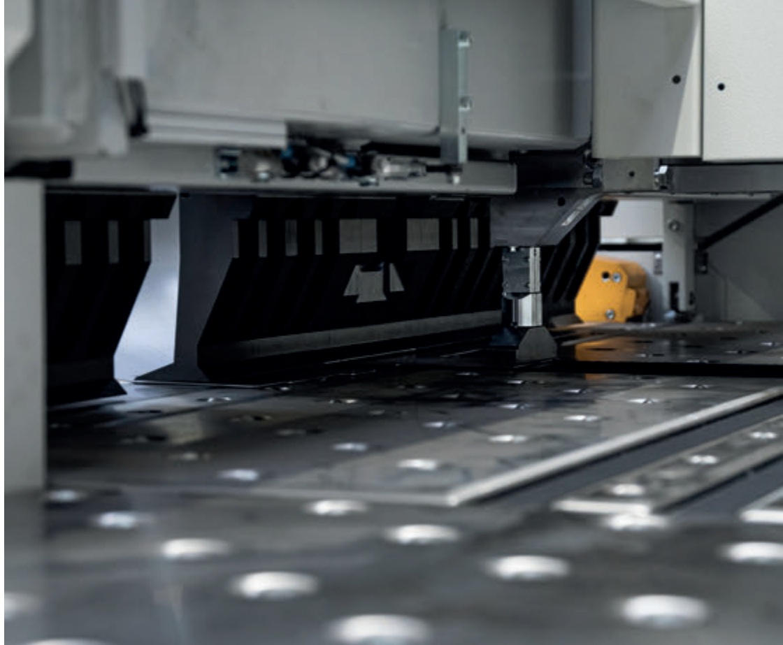
Le pieghe raggiate avvengono mediante l'azione di piega combinata con l'avanzamento automatico della lamiera a piccoli step.
