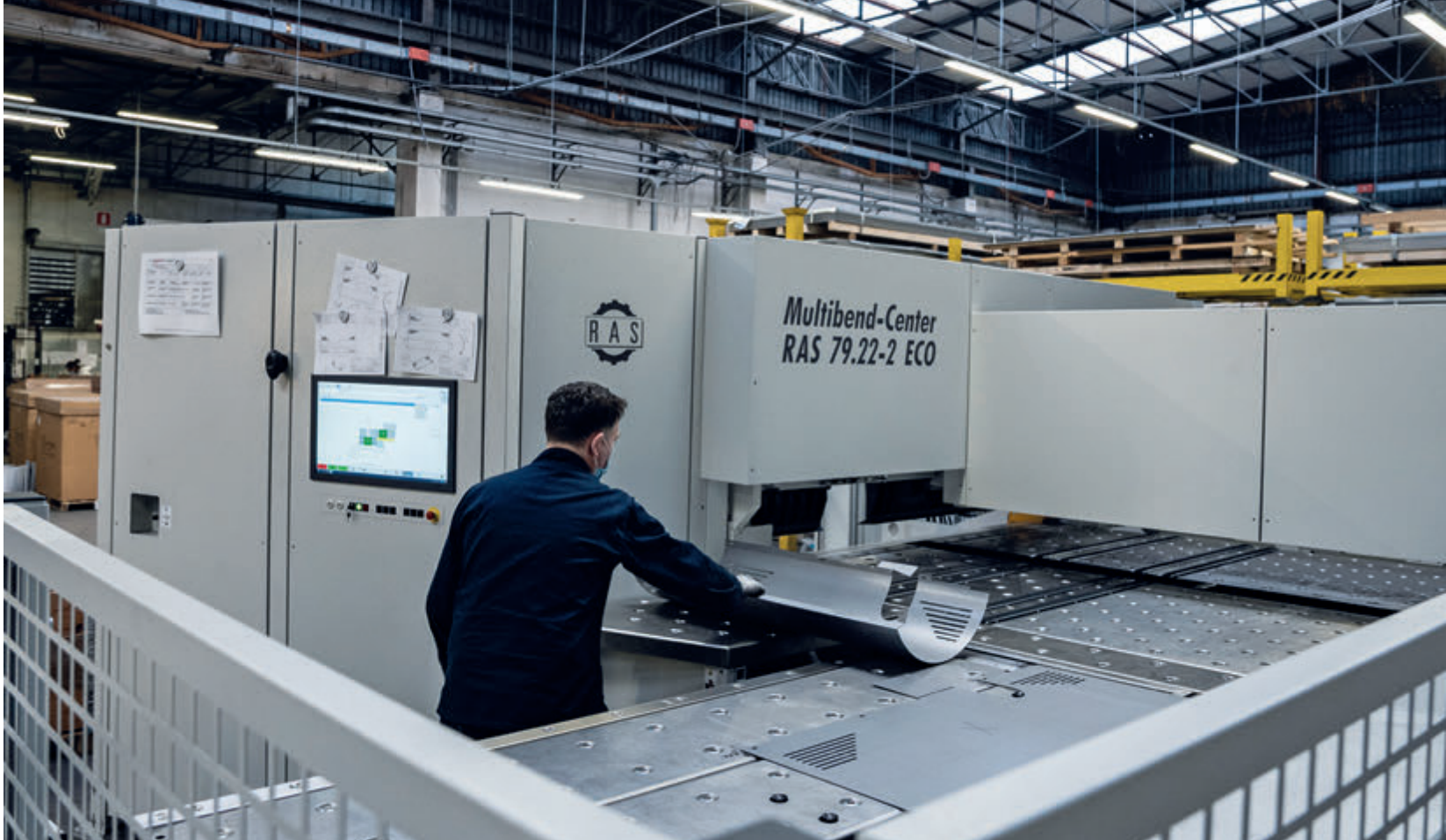
La Multibend-Center ECO ha risposto alle esigenze di produzione dei fianchi raggiati delle stufe che oggi Palazzetti produce in modo flessibile e qualitativamente ineccepibile.
