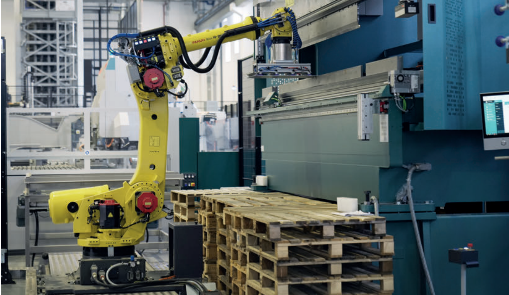
L'ultima stazione di lavoro della linea Daken è una cella robotizzata di piegatura ROBOformER.
