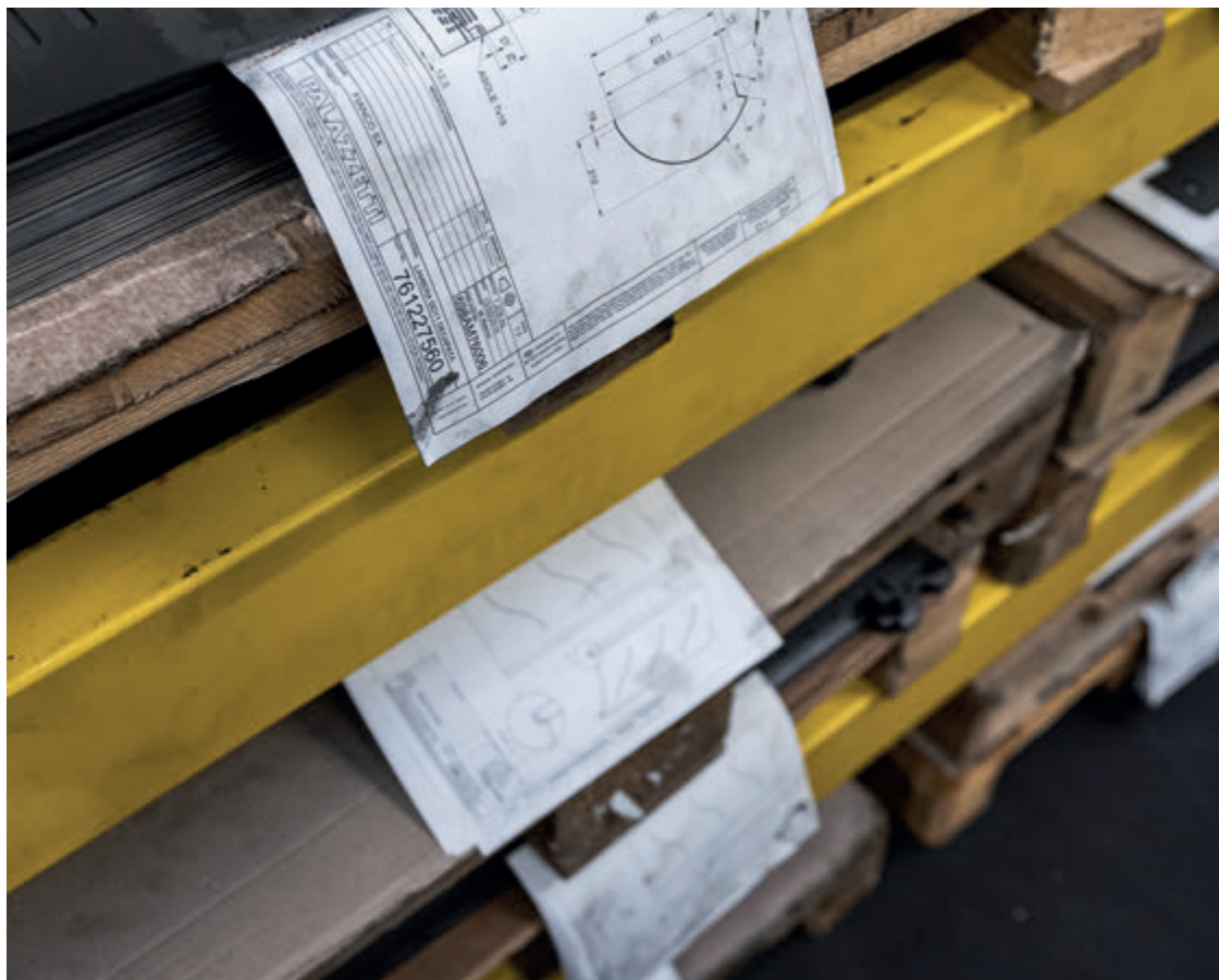
A monte della pannellatura, Palazzetti lavora secondo i principi kanban tenendo costantemente approvvigionato uno stock di semilavorati tagliati sempre disponibile, che viene via via rimpinguato in base ai consumi richiesti dal reparto di piegatura, dove lavorano, di fatto, a fitting.
