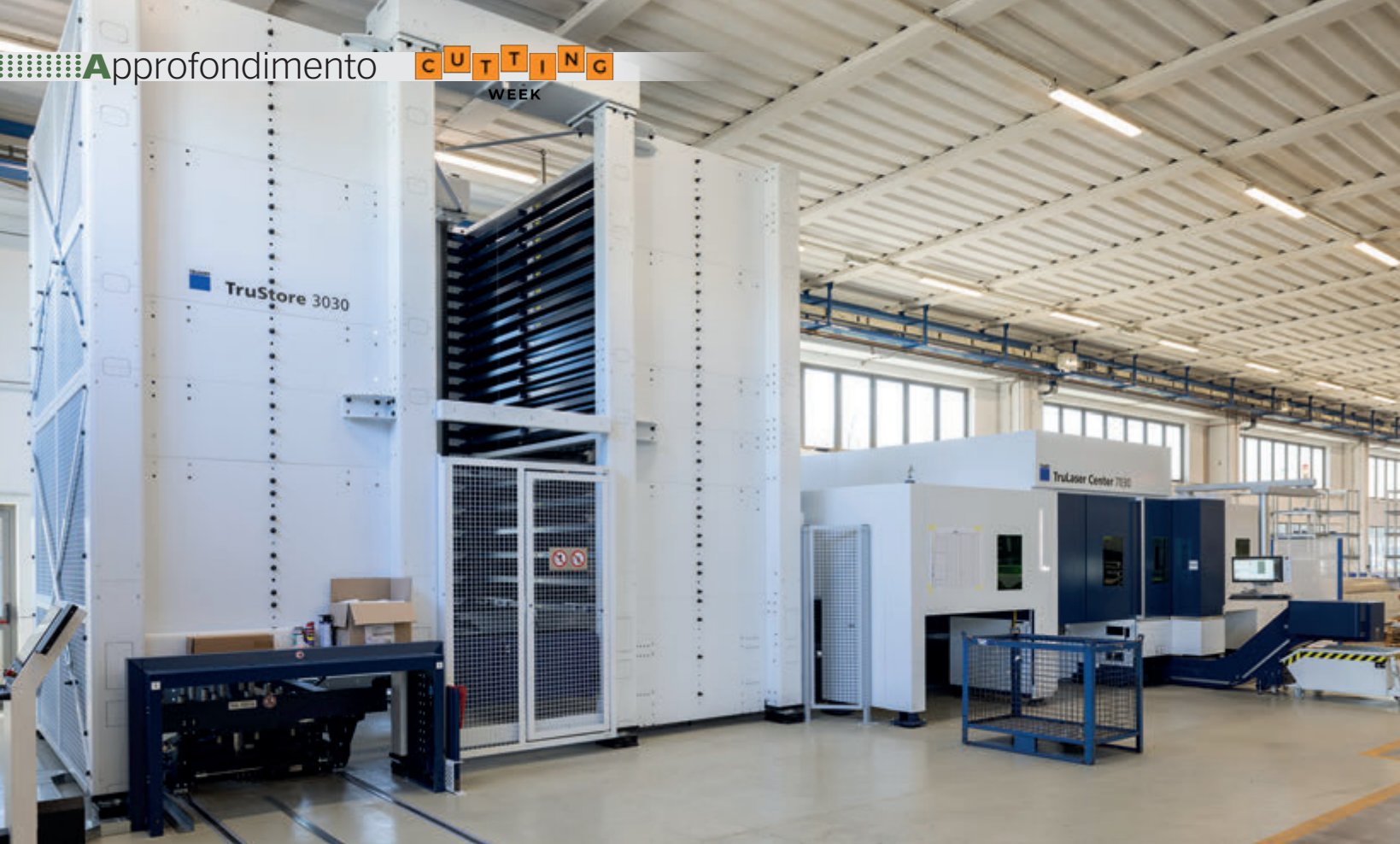
TruLaser Center 7030 integra per la prima volta tutti i processi del taglio laser in una sola macchina.
