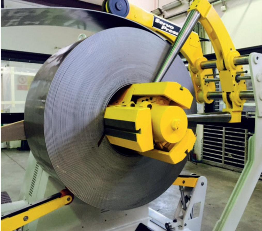
necessita soltanto di impostare il gap di entrata e uscita del rullo della raddrizzatrice. Solitamente, la testa raddrizzatrice alimentatrice lavora più materiale sul lato d'ingresso, con il gap del lato di uscita in prossimità dello spessore del materiale. All'aumentare della capacità della raddrizzatrice, si possono aggiungere rulli di backup o di supporto per evitare che i rulli di diametro inferiore devino. Un po' come per la progettazione di livellatore di precisione.
