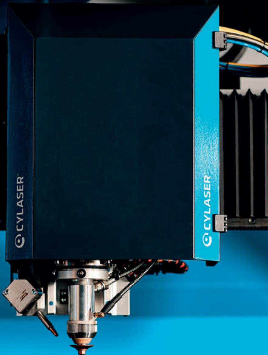
Come sappiamo, i bordi inclinati sono necessari per la preparazione alla saldatura e per altri metodi di assemblaggio finale. Malgrado sia possibile tagliare un bordo inclinato utilizzando un attrezzo per il taglio manuale, i bordi inclinati sono spesso tagliati per mezzo di una torcia o una testa di taglio specifica per il taglio inclinato e mon-
