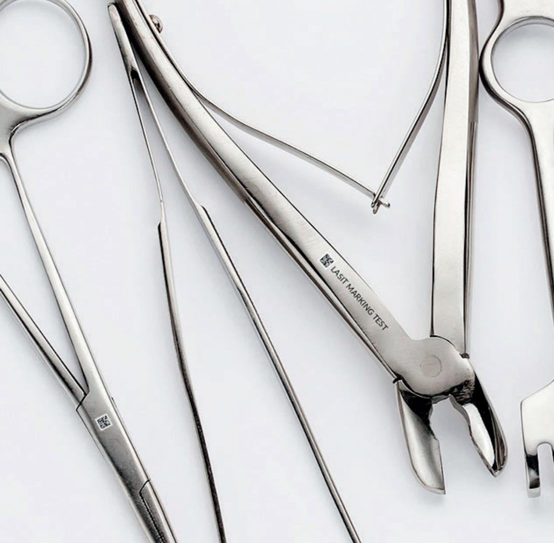
Il processo di marcatura laser ad ablazione superficiale consiste nell'asportazione della parte superficiale del metallo.
