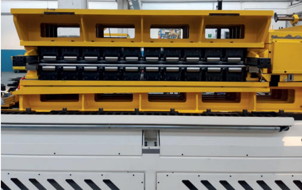
Questa linea è caratterizzata da un sistema automatico di sostituzione pacco rulli per raddrizzatrice di precisione che consente la gestione di un ampio range di spessori (da 0,7 mm a 8 mm).
