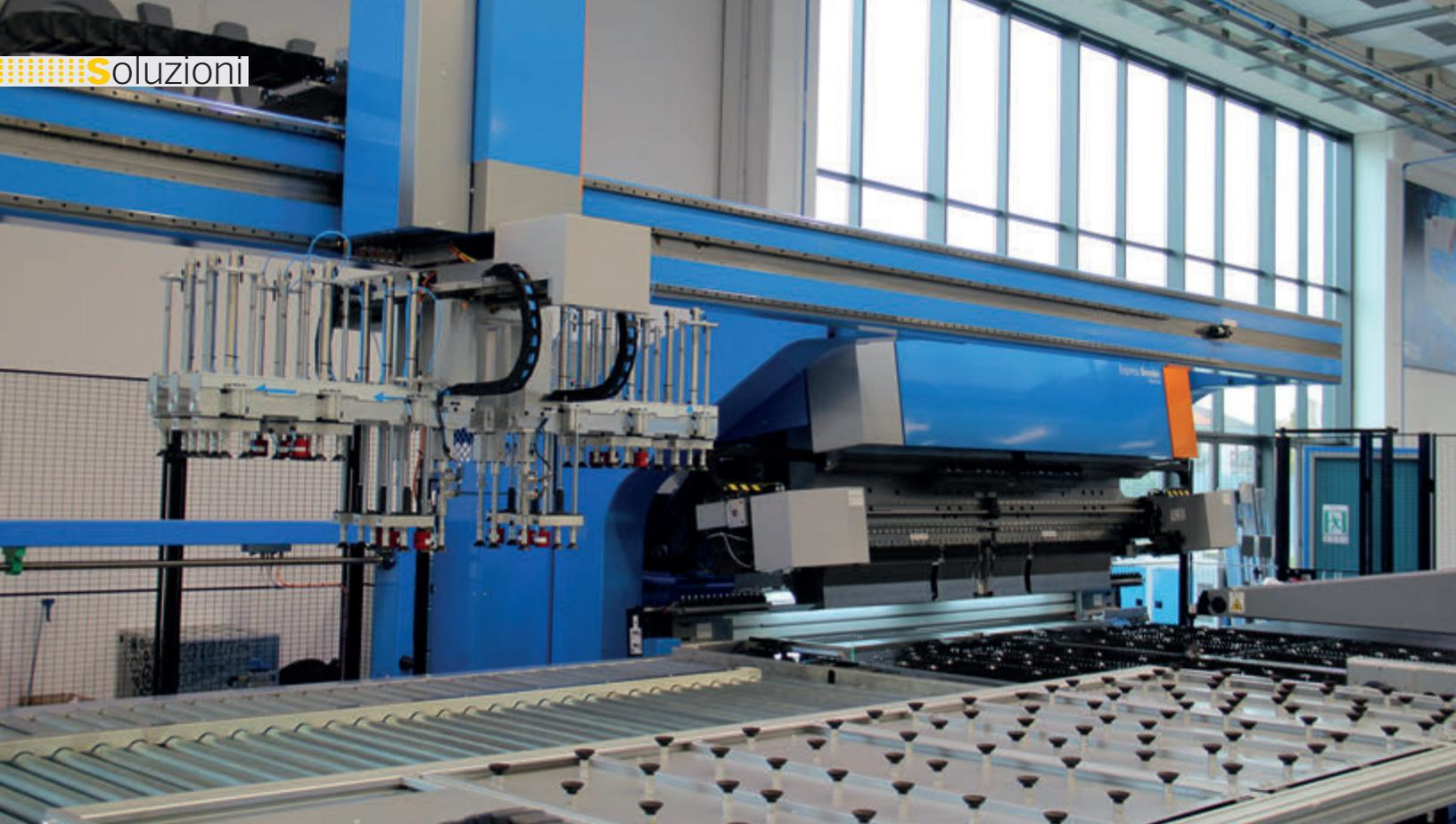
Pannellatrice Prima Power EBe FM con sistema di centraggio PCD e ribaltatore BTB.
