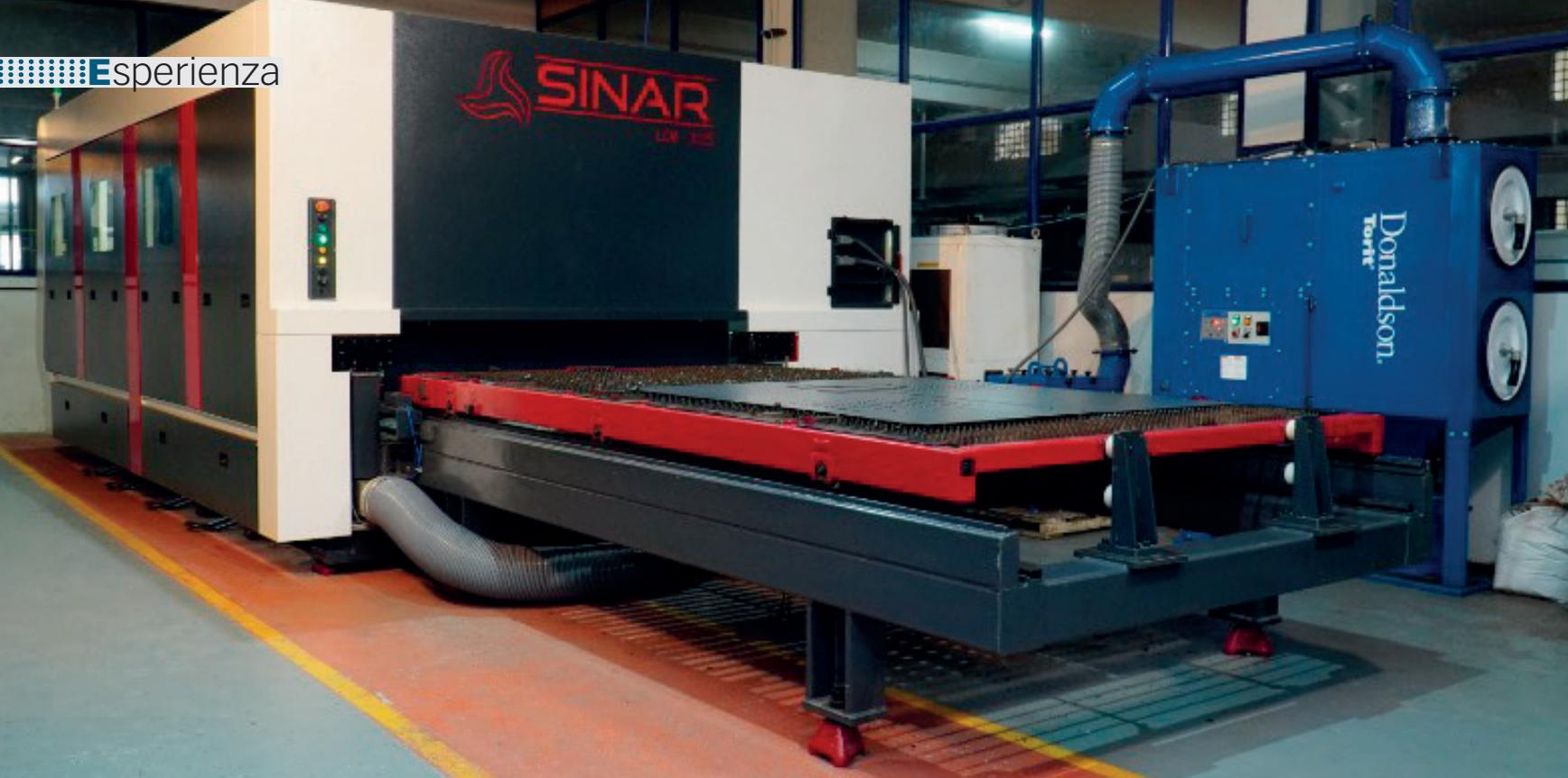
SINAR progetta e produce macchine per il taglio, la piegatura e la saldatura laser.
