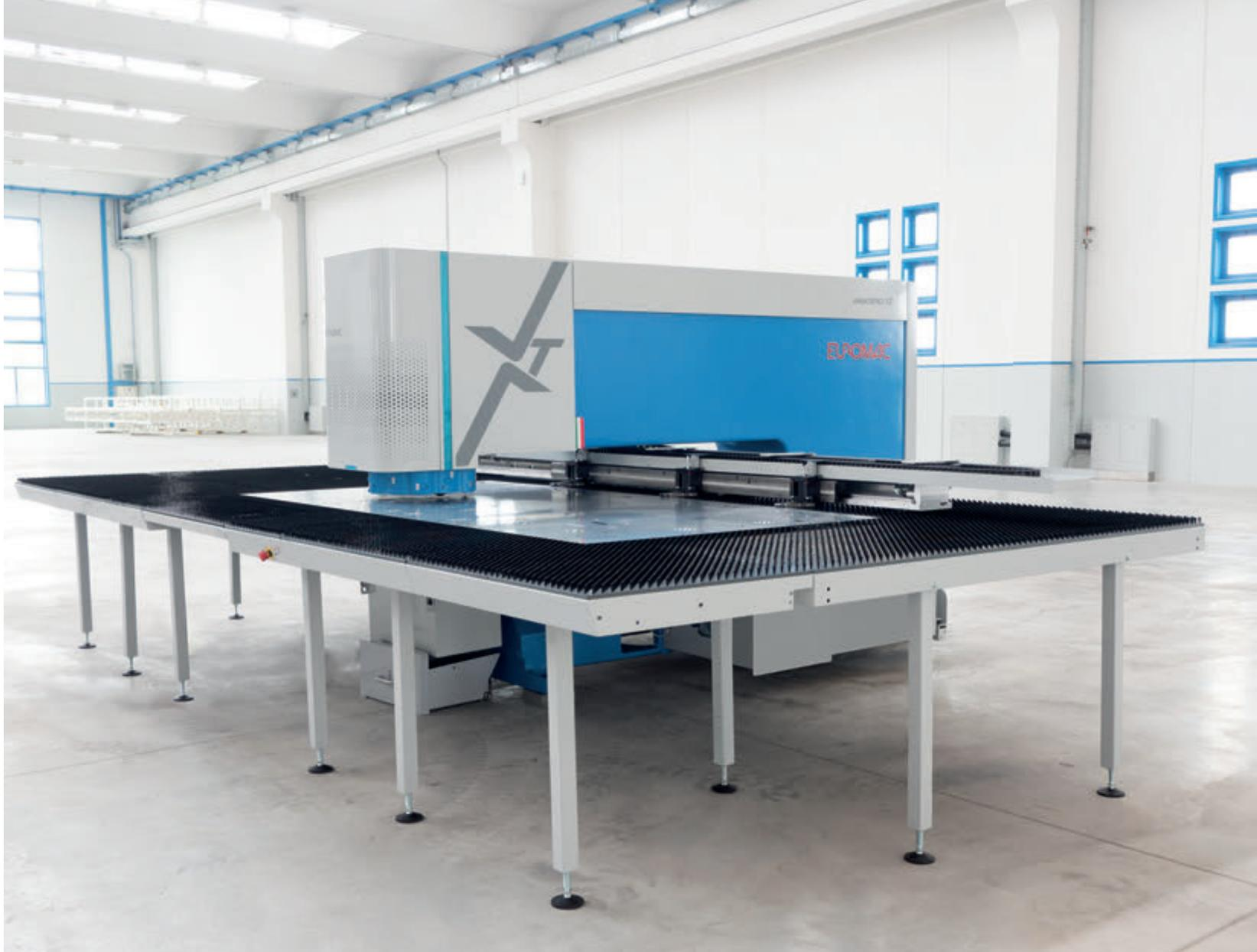
La serie XT è caratterizzata da una struttura monoblocco con il cilindro di punzonatura inserito direttamente nella fusione in modo da garantire stabilità e affidabilità.
