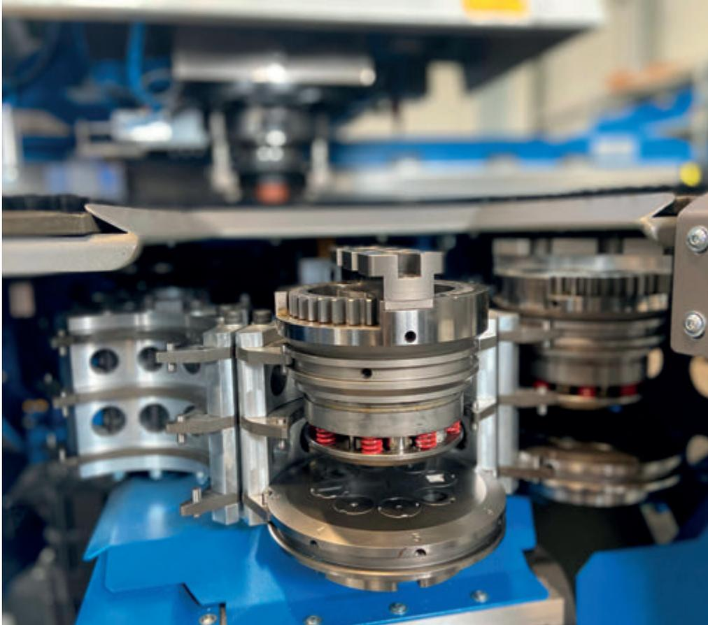
CombiLaser Multipunch è abbinata a una monopunzone da 280 kN dotata di torretta cambio utensili automatica a 8 stazioni.
