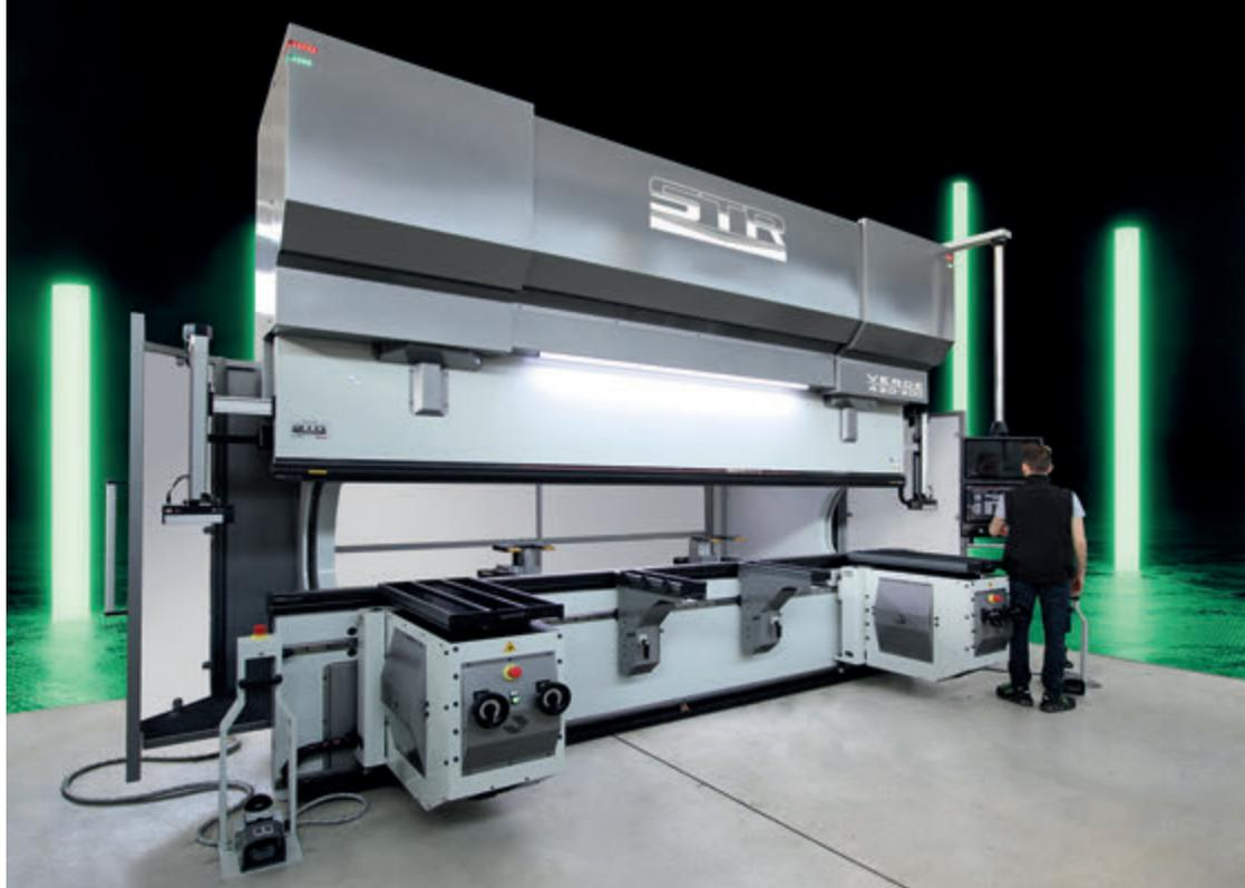
La pressa piegatrice Verde 420-200 di STR sprigiona una forza di 200 Ton con il piano utile di lavoro di 4250 mm, un'apertura di 750 mm e corsa utile di 420 mm.
