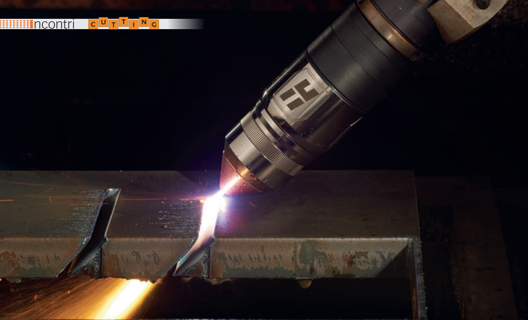
True Bevel consente di effettuare dei tagli bevel per necessità di montaggio e per creare inviti a successive lavorazioni di saldatura.
