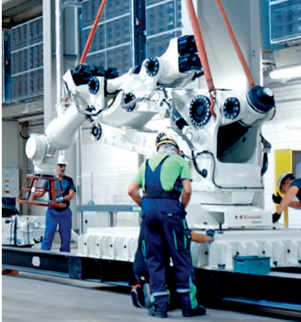
La serie M include i robot dedicati ai carichi extra grandi dai 350 ai 1.500 kg di portata con uno sbraccio di oltre i 4 m.
