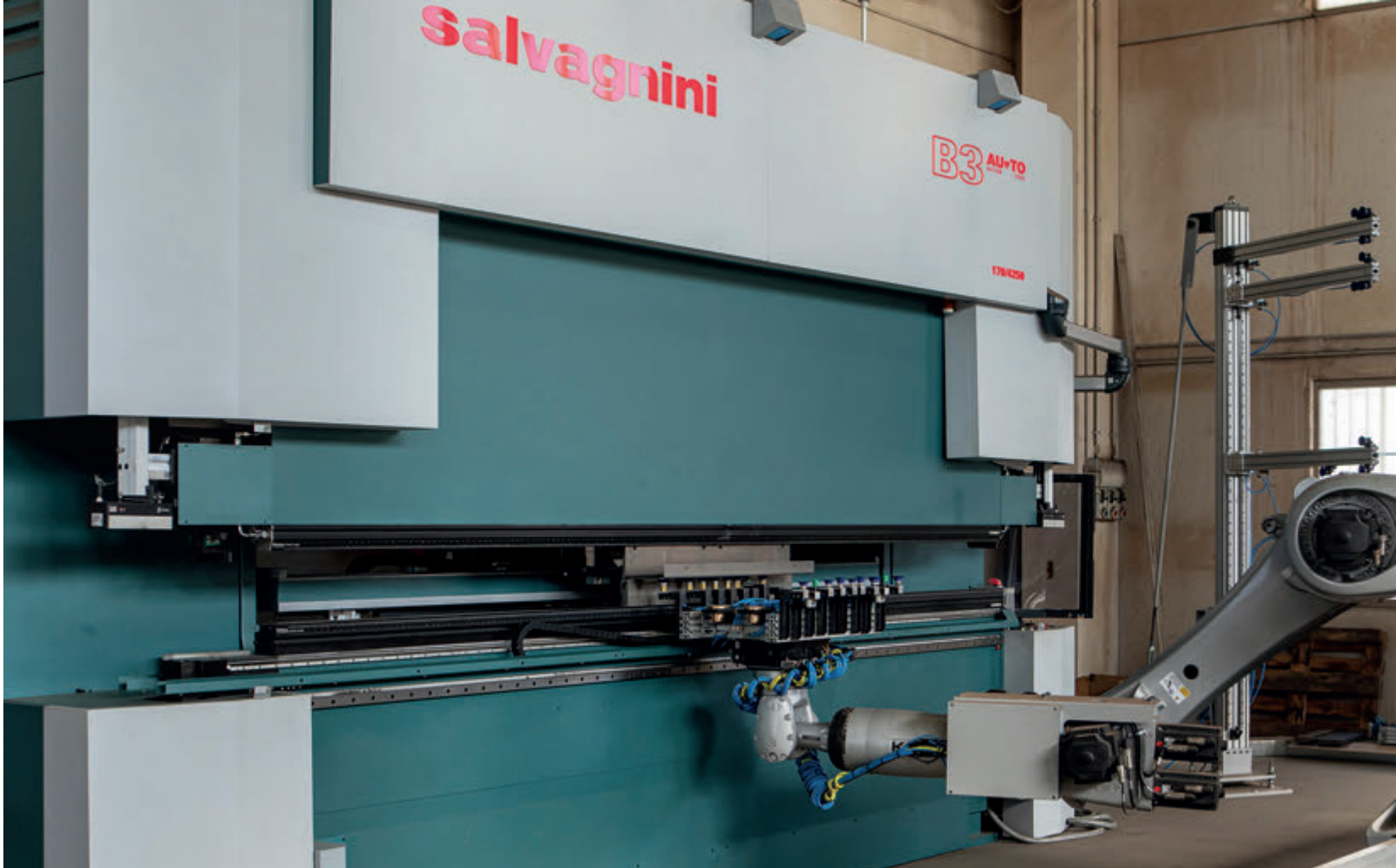
La cella di piegatura robotizzata Salvagnini ROBOformER installata presso BF Metal.
