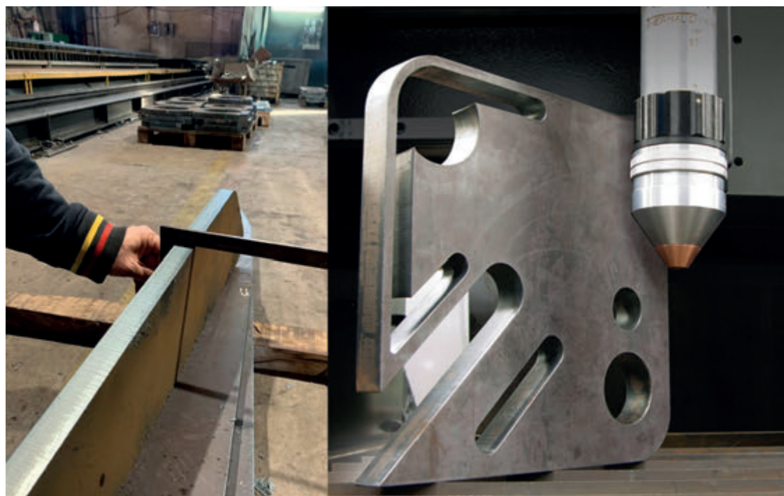
La tecnologia quick pierce assicura un significativo miglioramento della capacità di sfondamento su grossi spessori.
