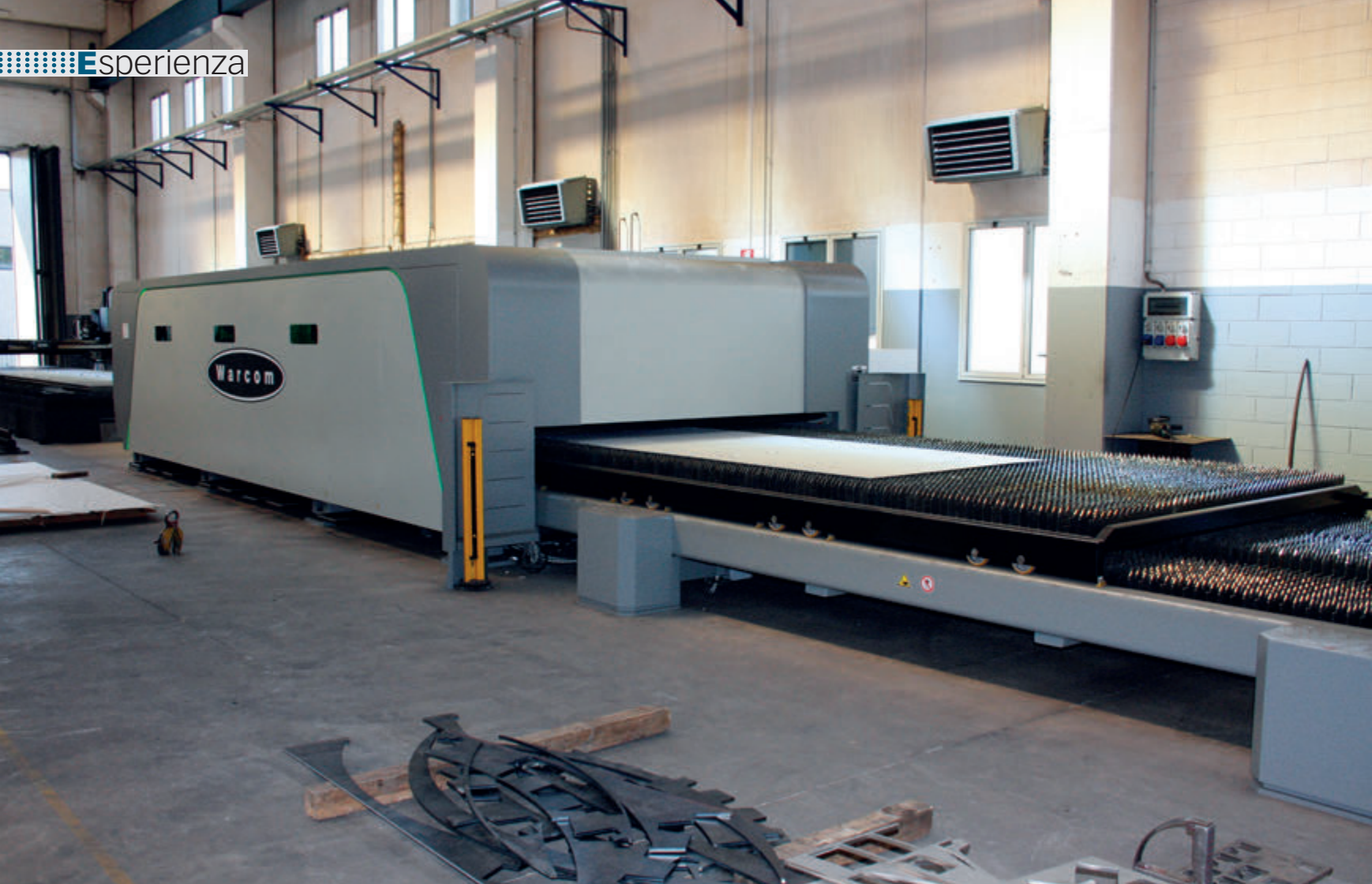
W-Fiber 25-60 dispone di campo di lavoro di 2.000 x 6.000 mm con sistema cambio pallet automatico.
