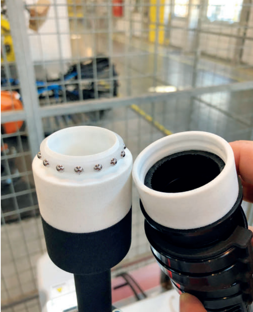
Prime prove con i collegamenti rotanti stampati in 3D: nei test, le forze assiali risultavano troppo elevate per la struttura. (Fonte: igus GmbH)
