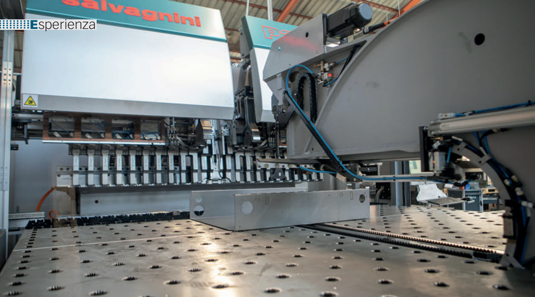
La pannellatrice P2lean Salvagnini installata di recente presso Metalsystem.
