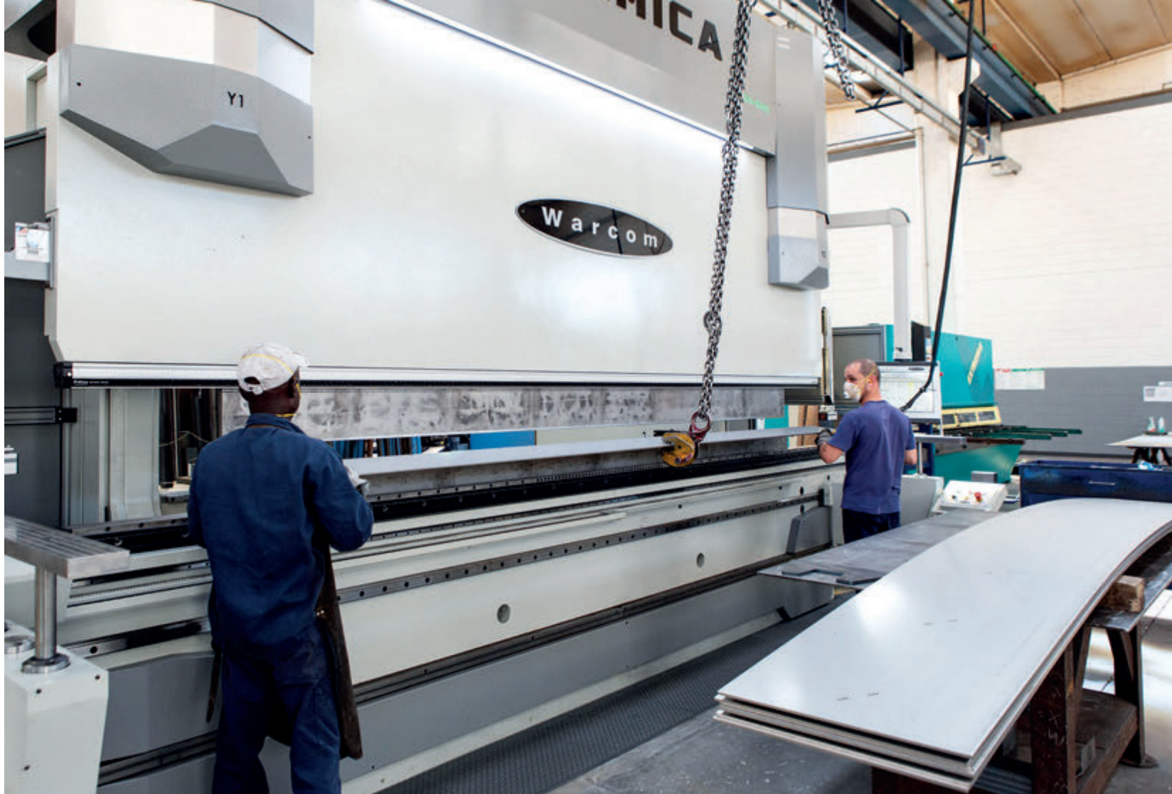
La DINAMICA 50-500 è a 6 assi con dispositivo di centinatura idraulica dinamica attiva DCS PLUS per il controllo delle flessioni e sensori per il controllo dello spessore in tempo reale.
