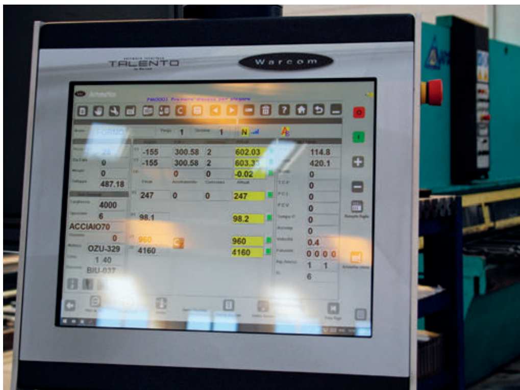
Il controllo numerico proprietario Talento con cui sono equipaggiate le macchine Warcom.
