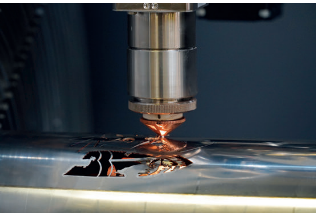
Si possono tagliare spessori da un minimo di 0,4 mm a un massimo di 2 mm per la TOP-S 400 e 3 mm per la TOP-S 600.
