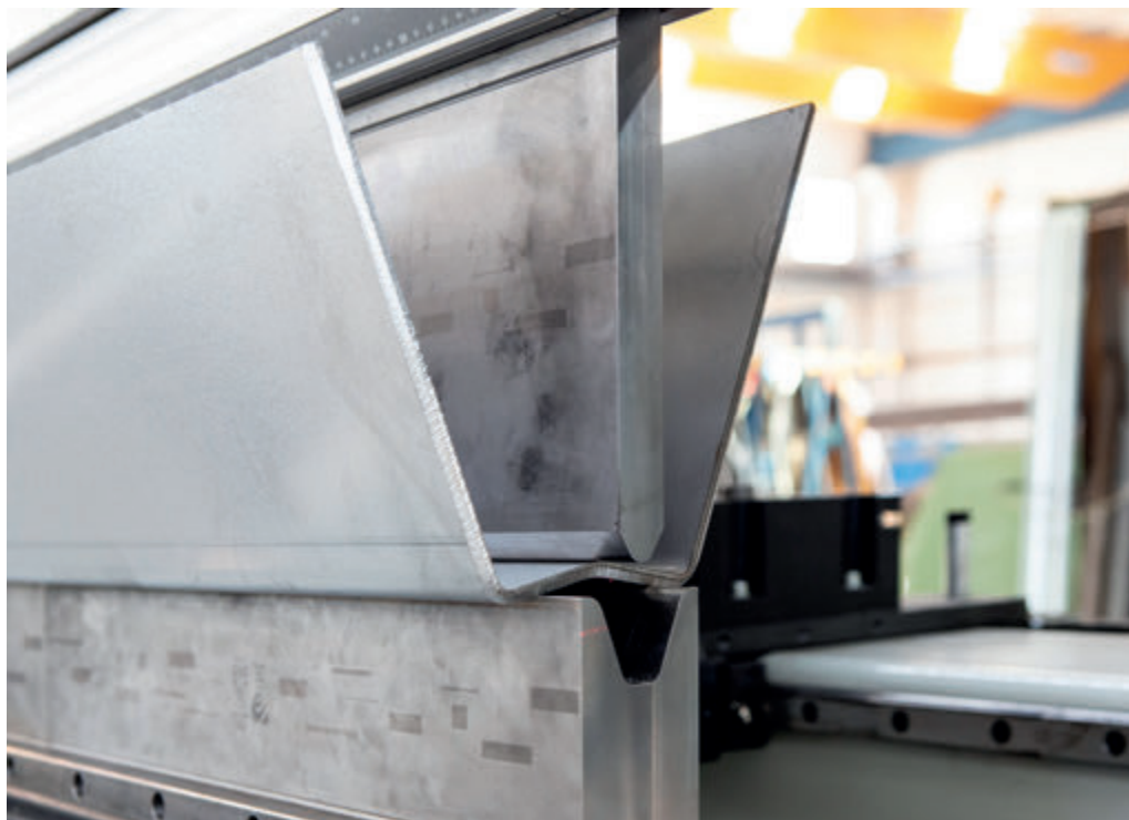
Il calcolo dell'angolo avviene mediante dispositivo BCS by Data-M "Cupra Laser Check" che rileva il valore reale dell'angolo di piega in ogni stante durante la fase di piegatura.
