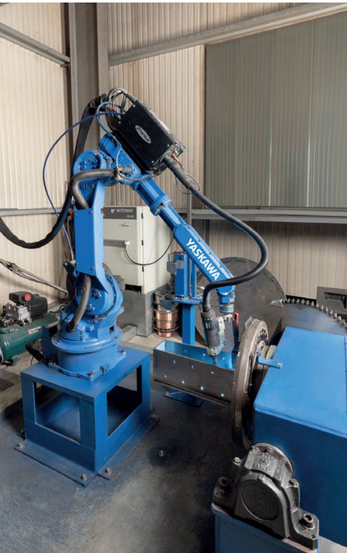
La cella di saldatura robotizzata ad alte prestazioni di Yaskawa integra un robot MOTOMAN HP20 con posizionatore a doppio asse.
