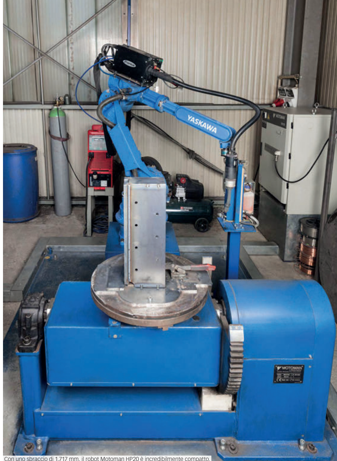
Con uno sbraccio di 1.717 mm, il robot Motoman HP20 è incredibilmente compatto.
