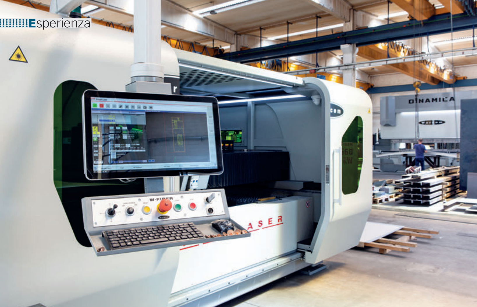
Il sistema di taglio laser W-Fiber 25-60 Warcom installato presso Carpenteria Santarelli.
