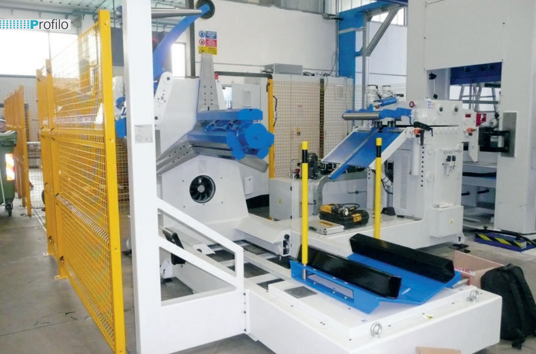
Linea compatta personalizzata per svolgere più coil contemporaneamente.
