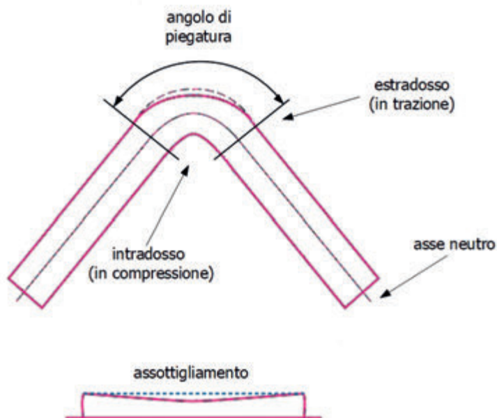
1. Rappresentazione schematica del processo di piegatura.
