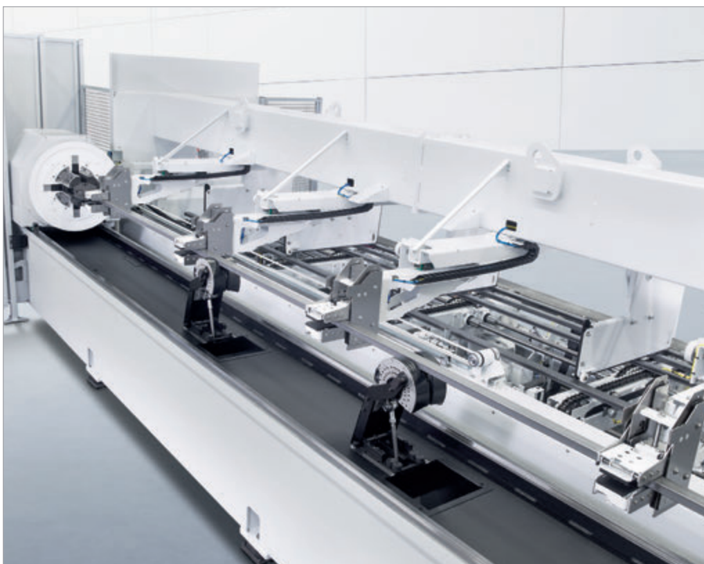
Il magazzino di carico barre, o area fascio tubi, offre un magazzino buffer in grado di contenere fino a 4 t di materia prima o fino a 5 t con la versione del carico da 8 m di lunghezza.
