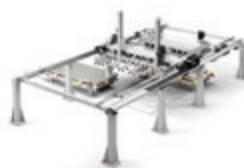
ADL: carico e scarico automatico su tavola
