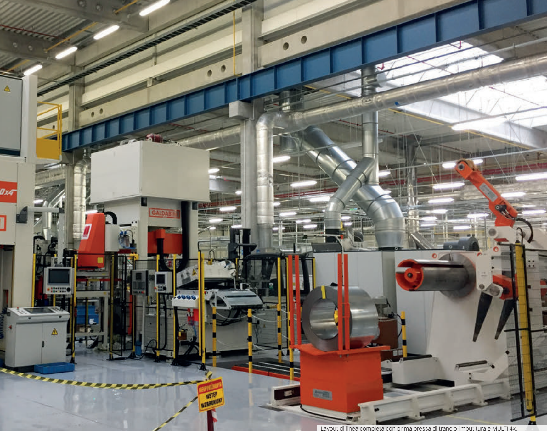
Layout di linea completa con prima pressa di trancio-imbuitura e MULTI 4x.
