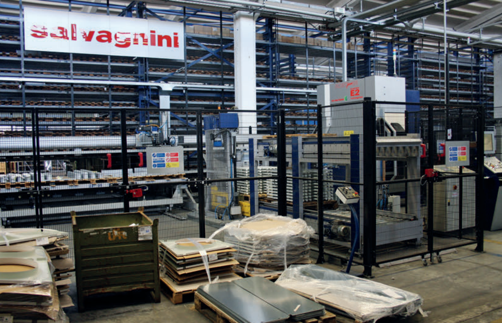
La cella di piegatura robotizzata Roboformer da 2 m con cui vengono piegati i particolari più piccoli.
