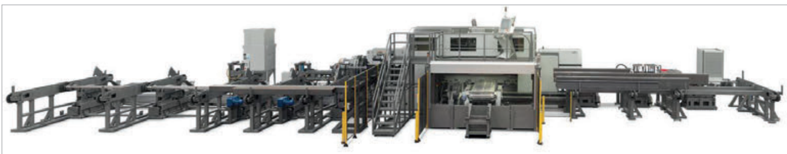
La svolta strategica di Morandi Steel è resa possibile grazie all'installazione della macchina laser 3D LT 20 JUMBO di ADIGE-SYS.
