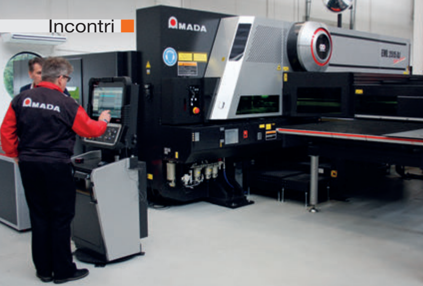
La tecnologia originale di AMADA per il controllo variabile del fascio è in uso già dal 2014 e permette un taglio altamente stabile sia di materiali sottili che spessi.
