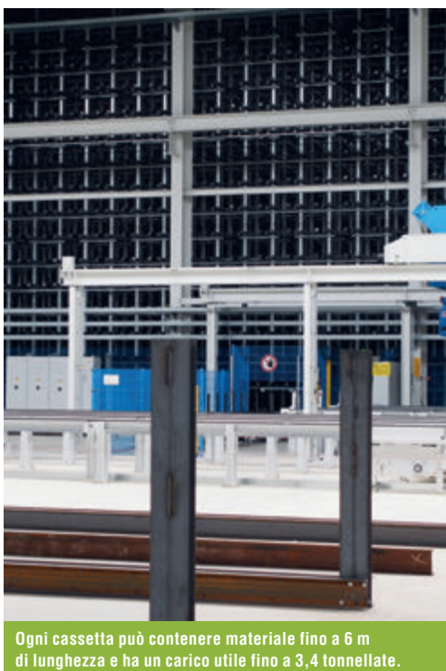
Il nuovo sistema di stoccaggio a nido d'ape KASTO UNICOMPACT contiene oltre 10.000 cassette.
