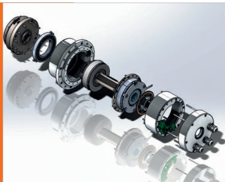
A sinistra, disegno di un giunto robotico a T e, a destra, la sezione trasversale che mostra i diversi componenti del giunto.
