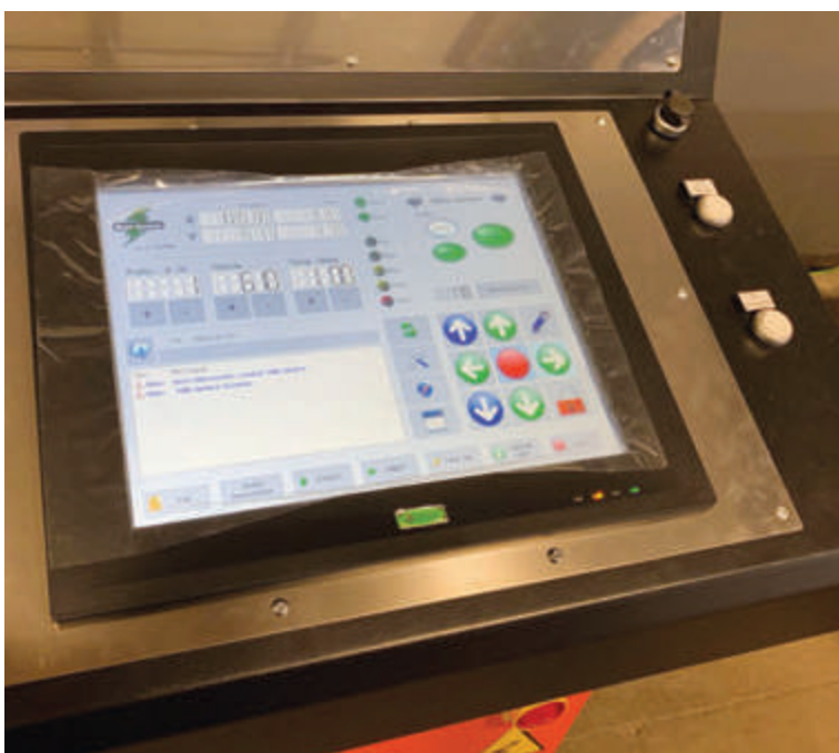
La gestione delle gas console automatiche dei generatori plasma consente anche di marcare e tagliare i pezzi in un solo passaggio.
