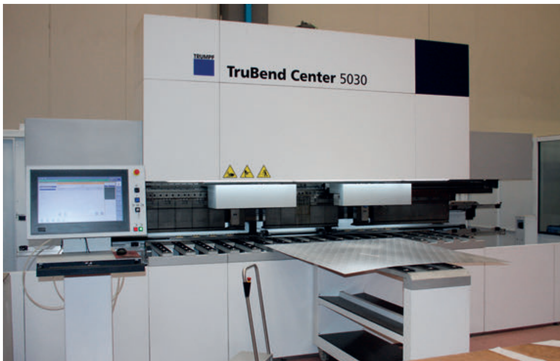
La pannellatrice TruBend Center 5030 installata da Fedegari.
