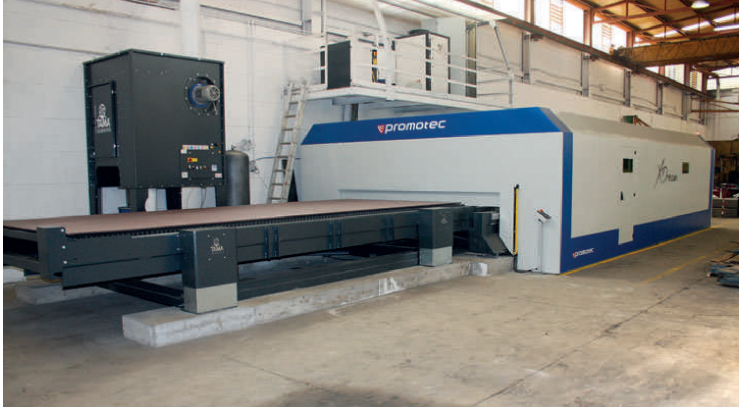
Il sistema di taglio laser Promotec XDream fiber è dotato di dispositivo cambio pallet.
