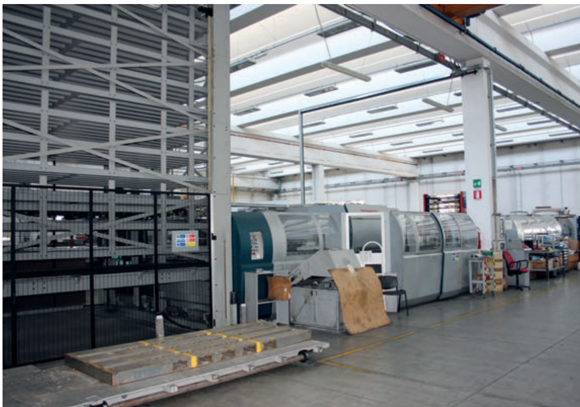
La linea di punzonatura Salvagnini S4 acquistata da Padovalamiere nel 2004.
