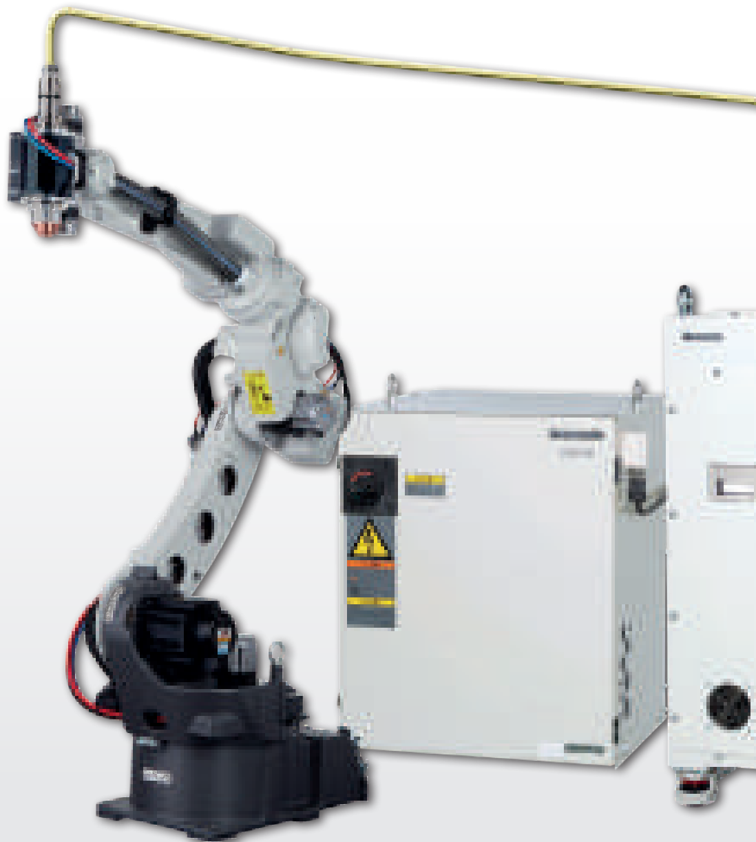
1. Il robot integrato di saldatura laser Panasonic LAPRISS.
