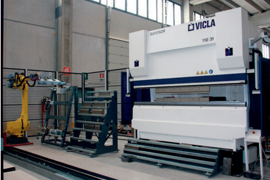
La piegatrice Vicla Superior 110/31 viene sfruttata stand alone per realizzare le campionatura.
