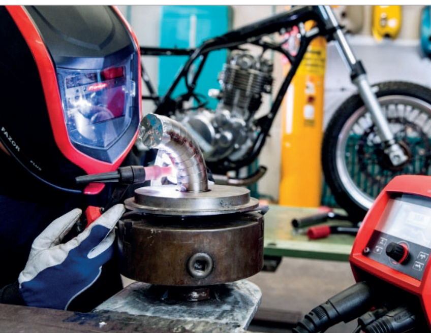
MagicWave 230i fa parte della nuova generazione di dispositivi TIG che offrono un controllo intuitivo e migliori proprietà di accensione e saldatura.
