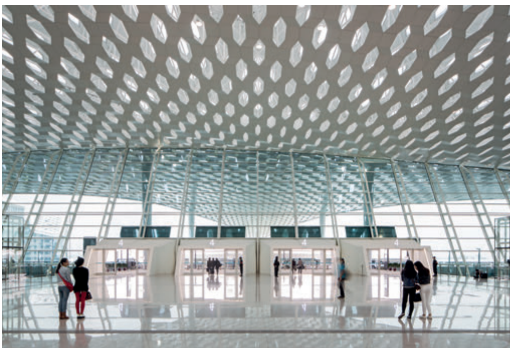
L'elemento simbolo del progetto è il motivo a nido d'ape che avvolge la struttura portante per un totale di 25.000 elementi in carpenteria metallica e vetro.
