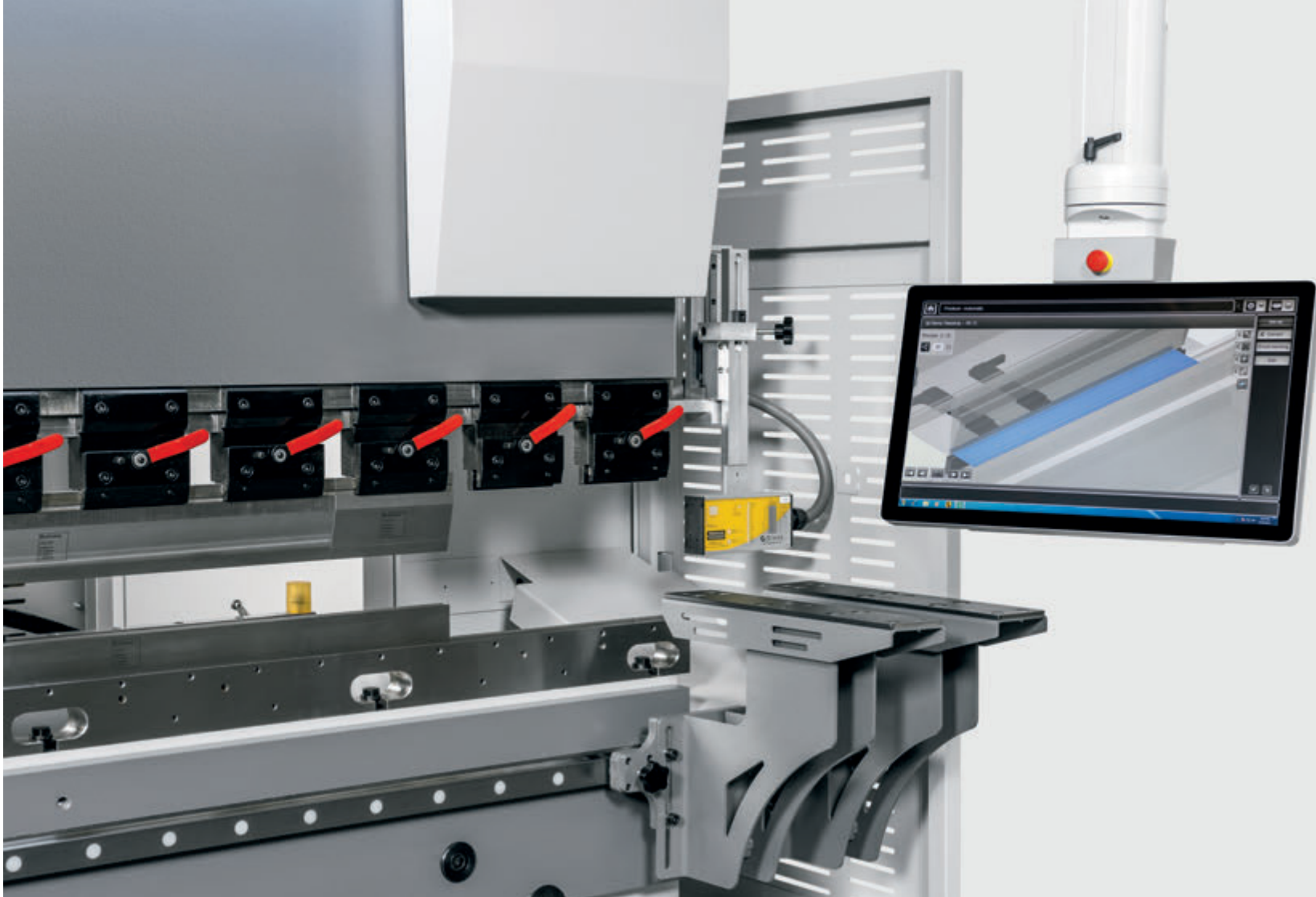
Tutte le fasi di piegatura vengono comandate dall'operatore tramite lo schermo tattile del software di processo ByVision Bending.
