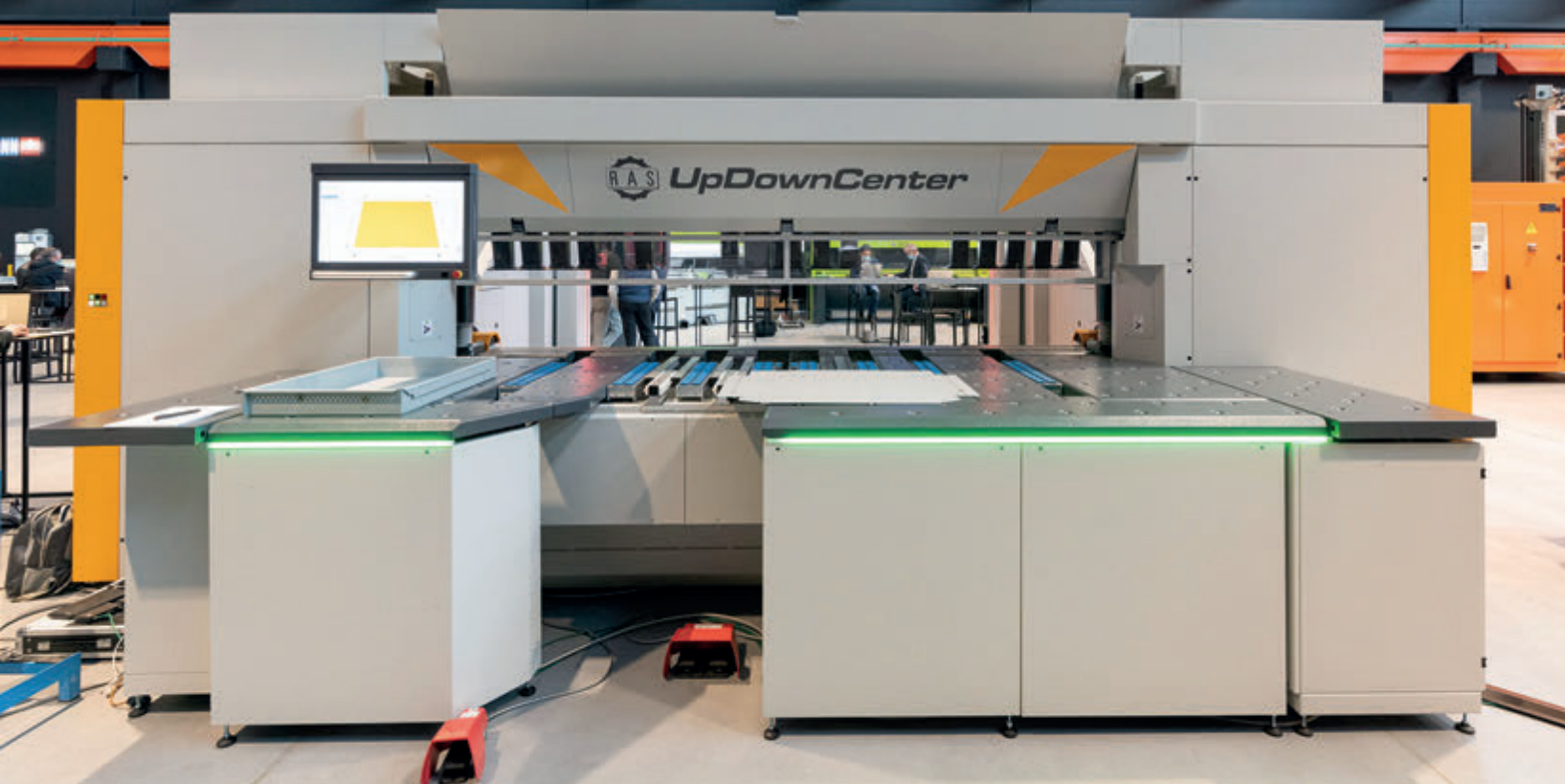
La pannellatrice a bandiera semiautomatica RAS Up Down Center in mostra nello show room.
