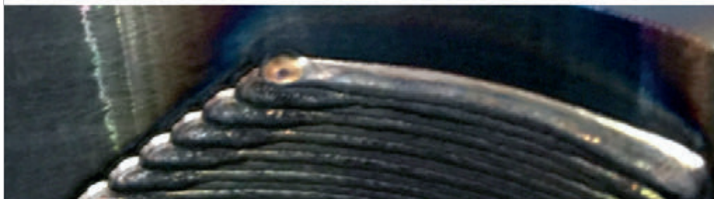
Superficie placcata ottenuta dalla modalità Patch inclusa inversione e correzione della velocità di saldatura.
