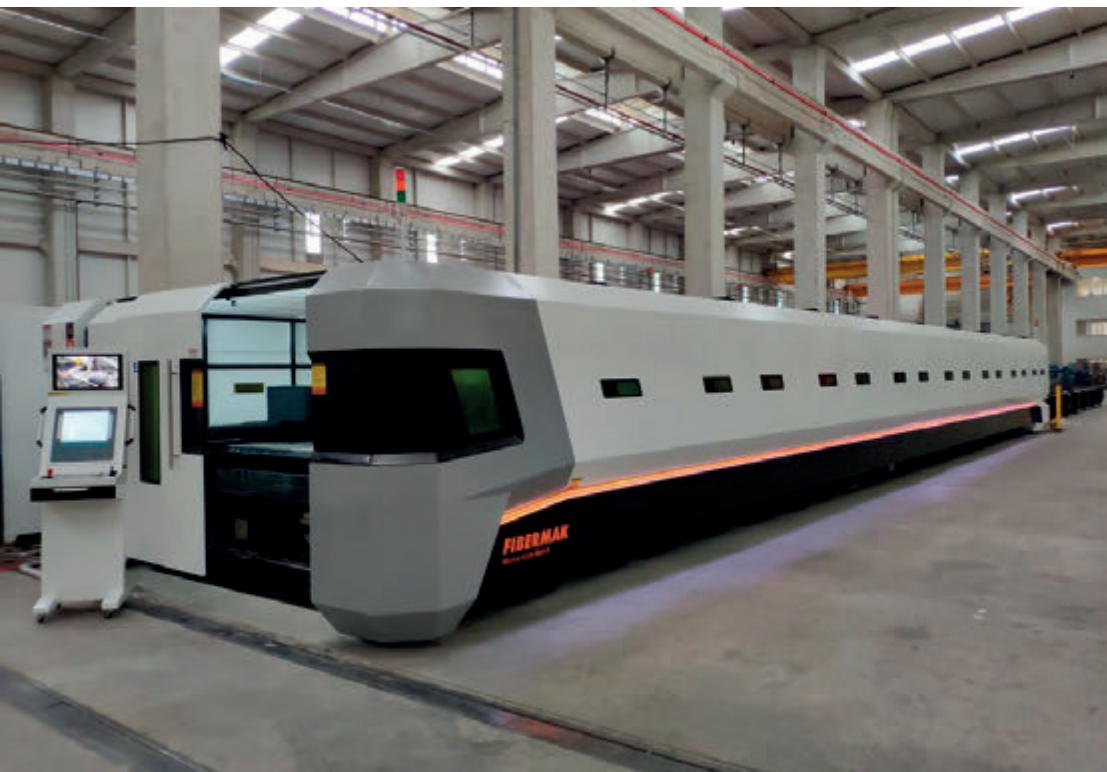
Co.Ma.F. propone la linea di macchine taglio laser a fibra Fibermak di Ermaksan, qui in versione da 18 m.
