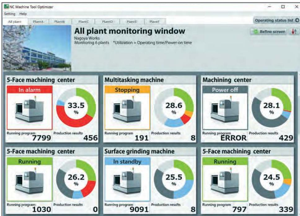
NC Machine Tool Optimizer è in grado di interpretare le informazioni ricevute da diverse macchine utensili dotate di qualsiasi unità CNC e di NC Machine Tool Connector per mettere a disposizione una piattaforma intuitiva per la visualizzazione e il monitoraggio dei processi.
