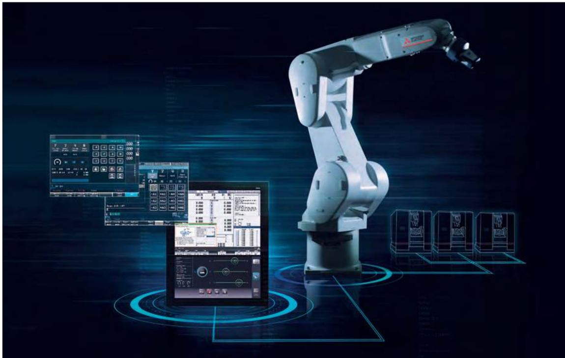
La funzionalità DRC (Direct Robot Control) consente agli operatori di macchine utensili di programmare rapidamente i robot direttamente dal pannello CNC, senza competenze specialistiche.
