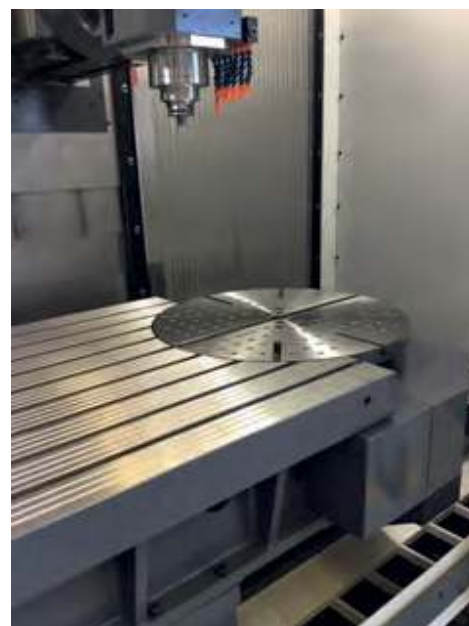
La piattaforma della tavola diametro 1.000 o 1.200 mm è annessa tra due semitavole oppure affiancata da una semitavola sagomata.
