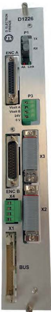
Scheda di regolazione All in One D1226 per azionamenti Simodrive® 611 monoasse.
