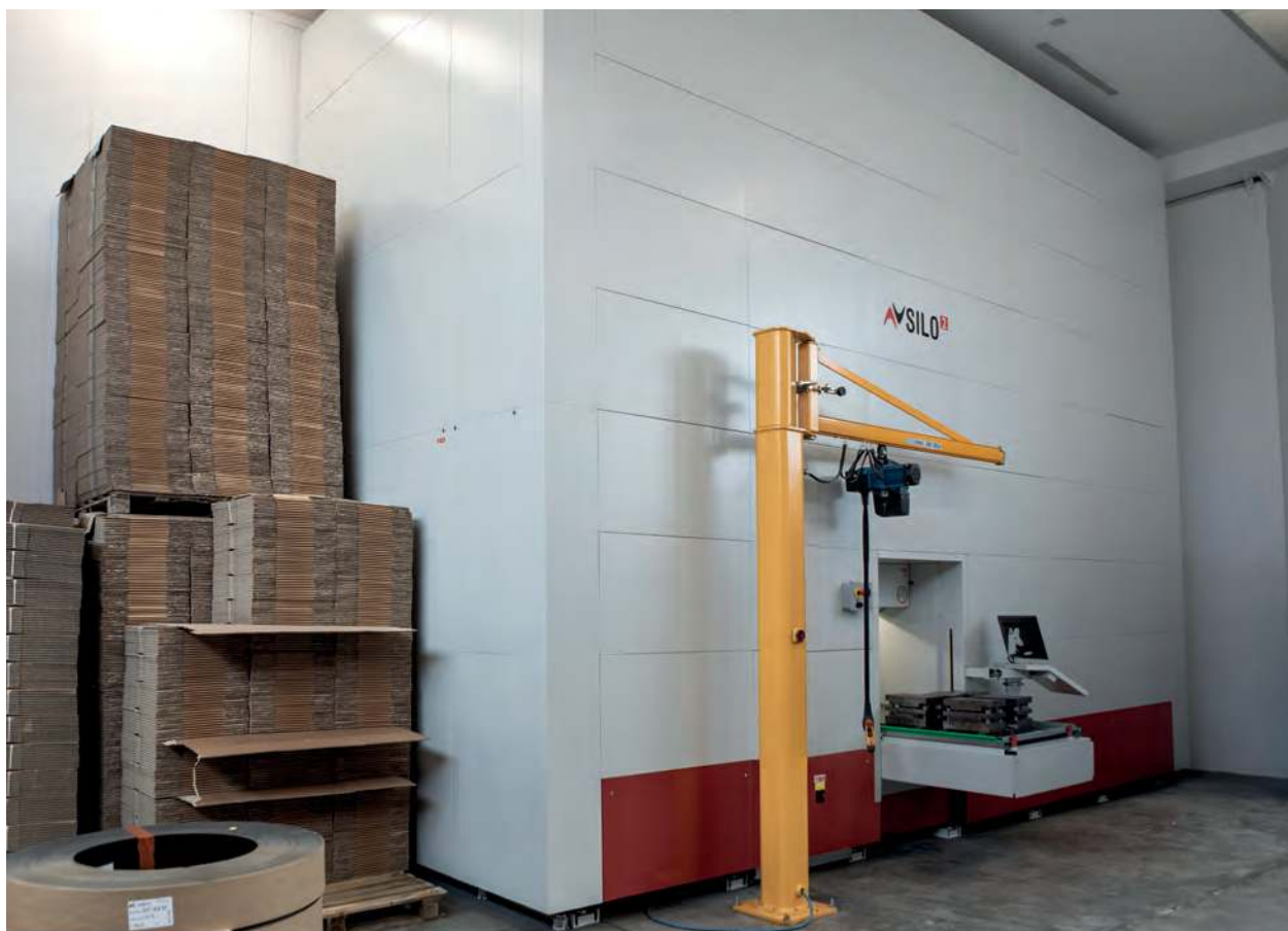
Magazzino verticale SILO 2 : oltre 500 stampi stoccati in soli 23 m 2 .
