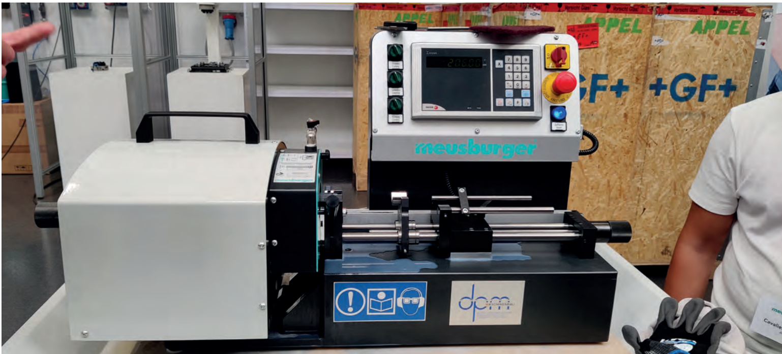
III Macchina da taglio e da rettifica di precisione per espulsori GMT 6000 di Meusburger.
