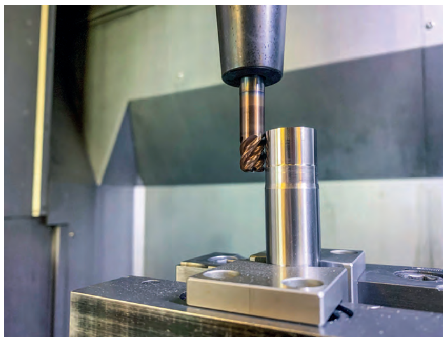
III Dopo la sgrossatura trocoidale con una OptiMill-Tro-H, la finitura del punzone avviene con una OptiMill-3D-CR-Hardened.
