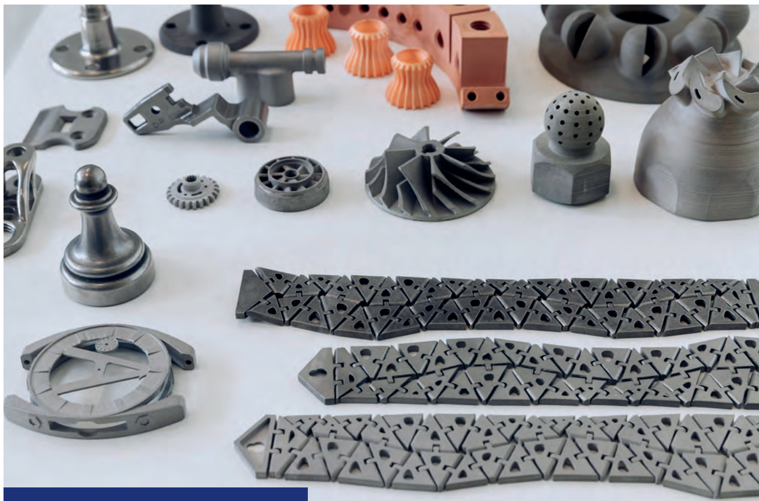
ESEMPI DI COMPONENTI STAMPATI IN METALLO DA ELMEC 3D.
