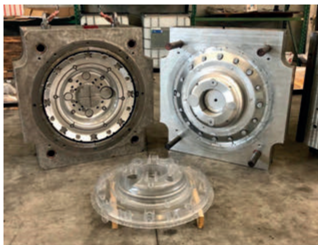
III Stampi per articoli in policarbonato di circa 11 kg cadauno. Uno stampo è caratterizzato da 36 movimenti idraulici a camma per le sedi degli insufflatori.
