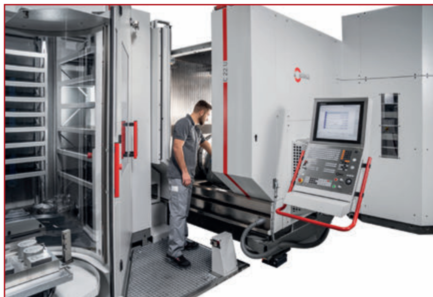
III Sistema robotizzato RS 1 con magazzino a scaffali a 3 moduli, nell'adattamento per due centri di lavoro Hermle C 22 U.
