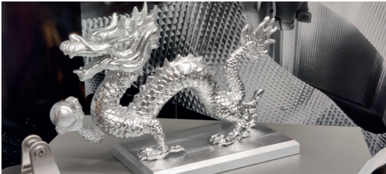
III Drago realizzato sul centro C 42 U.
