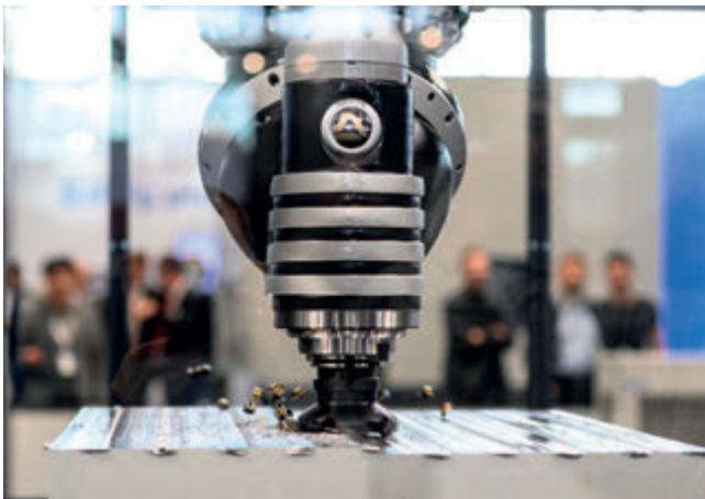
III Lavorazione su una fresatrice Soraluce.
