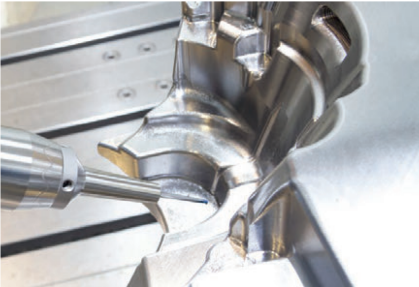
||| Lavorazione di uno stampo con fresa Max Tool.
