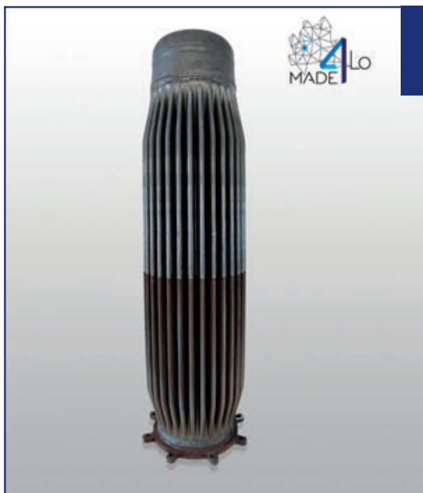
RECUPERATORE COMPLETO DOPO I TEST IN ESERCIZIO.
