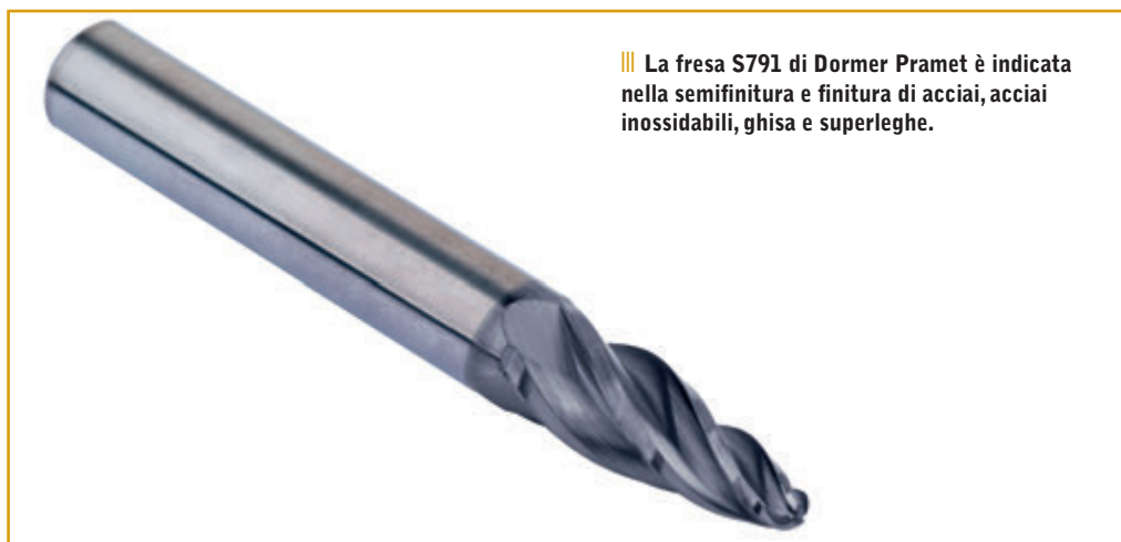
||| L'angolo di spoglia superiore positivo della fresa a barile S791 assicura un'azione di taglio dolce nella lavorazione di acciaio inossidabile e super-leghe, riducendo in questo modo il rischio di indurimento superficiale.
