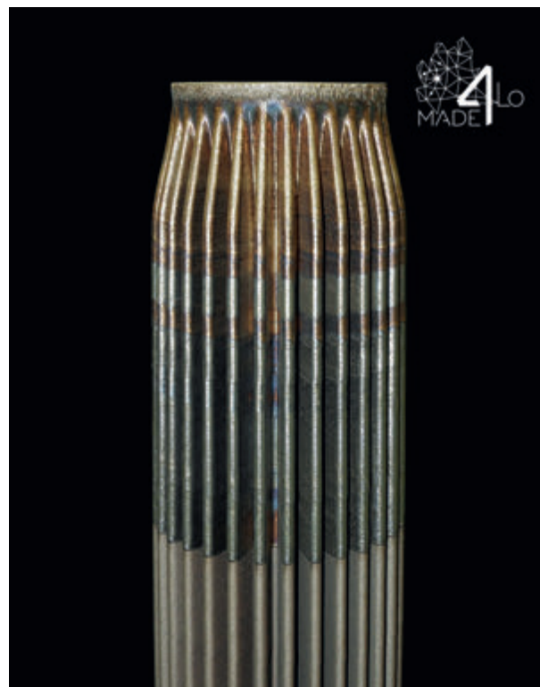
PARTICOLARE DELLA SUPERFICIE DEL RECUPERATORE, CON DISTINZIONE TRA I DUE MATERIALI.
