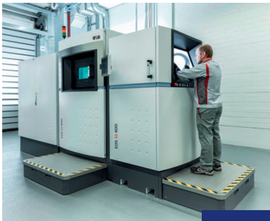
AUDI UTILIZZA LA STAMPANTE INDUSTRIALE 3D EOS M 400 PER PRODURRE SEGMENTI DI STAMPI.
