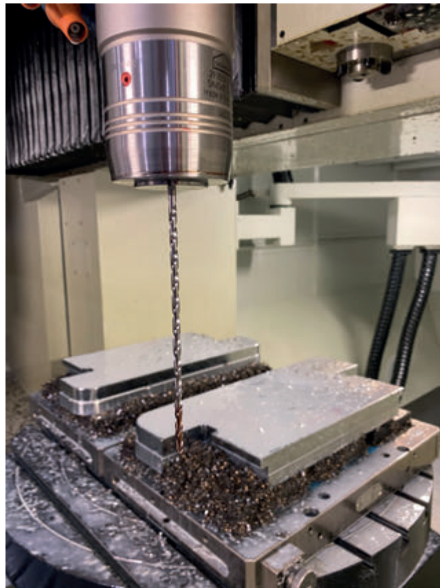
||| Punta MOLDINO diametro 4 mm, lunga 30 volte il diametro.
