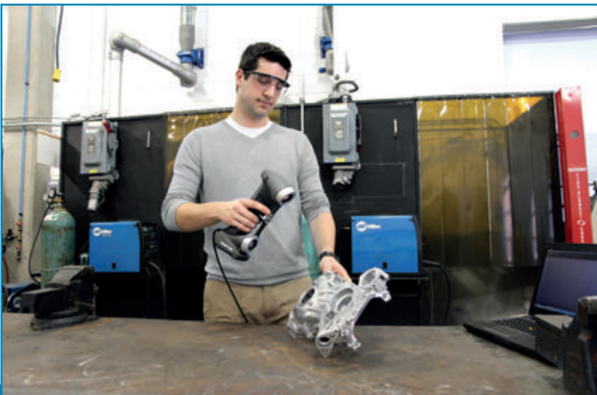
III La serie SILVER consente di acquisire misurazioni 3D altamente accurate e ripetibili su superfici complesse in qualsiasi posizione.
