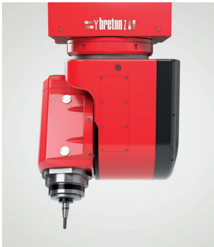
III La testa Typhoon HD, dotata di motori Torque ad alta efficienza su entrambi gli assi.
