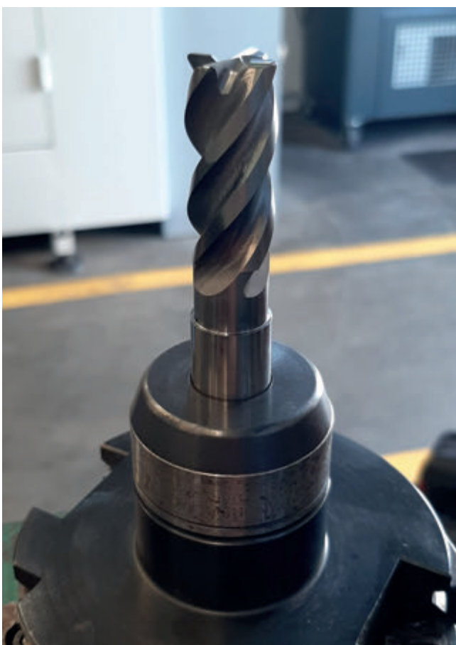
III Fresa MOLDINO EPSM diametro 16 mm utilizzata per lavorazione in slotting, taglio piastra in 1.2311.
