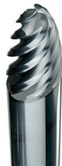
III Il design con geometria a barile a tagliente multiplo della fresa VQT6UR di Mitsubishi Materials garantisce una lavorazione più efficiente, mentre la geometria irregolare del passo dell'elica previene le vibrazioni e gli ampi vani di scarico migliorano l'evacuazione dei trucioli.
