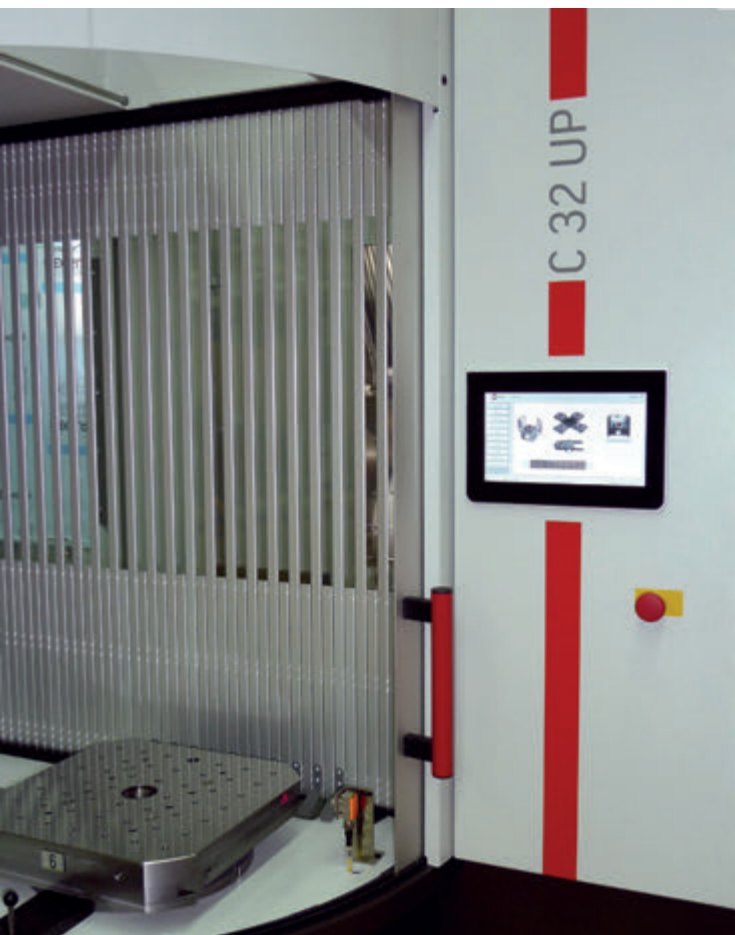
III HACS (Hermle Automation Control System) con a fianco baia di carico.
