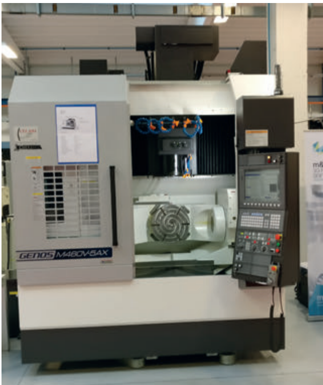
III Il centro di lavoro verticale a 5 assi GENOS M460V-5AX di Okuma.
