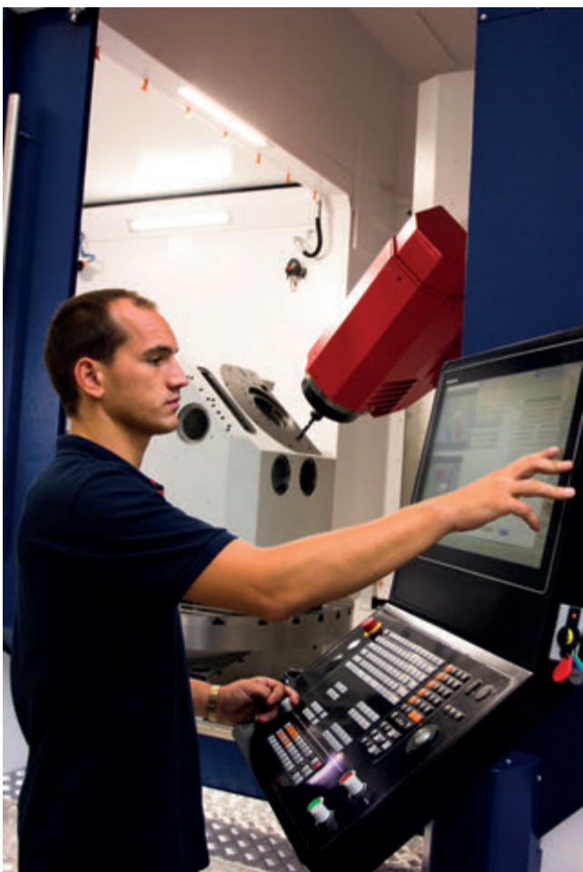
III Facile accesso all'area di lavoro e posizione ergonomica del pannello operatore con schermo touch 24".
