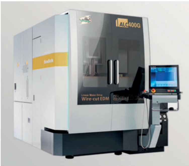
III Le corse della macchina ALC400G sono 400x300x250 mm.
