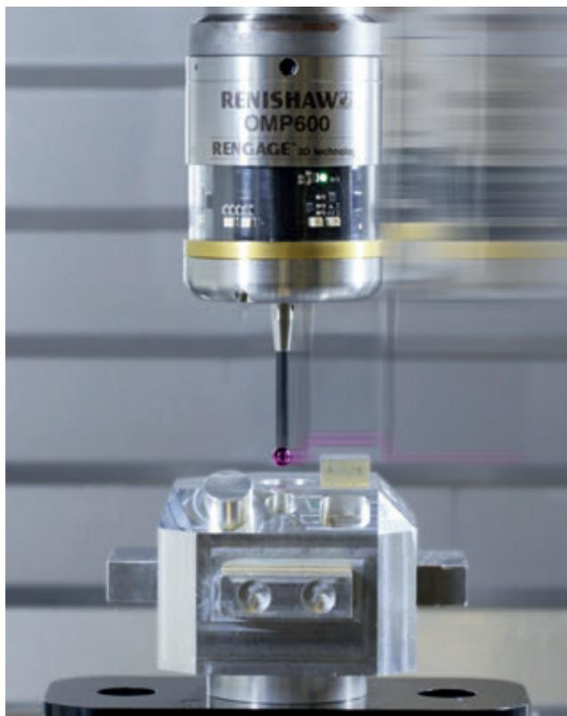
III SupaTouch è una tecnologia in grado di determinare in modo intelligente la velocità massima che una macchina utensile può raggiungere senza compromettere la ripetibilità delle misure.
