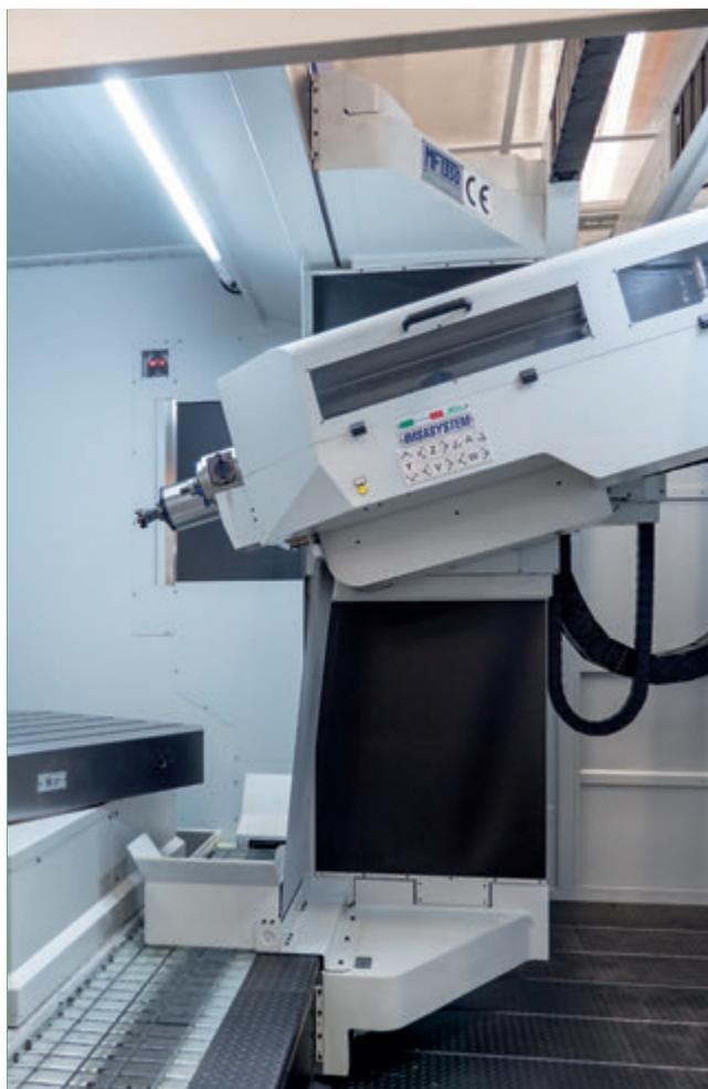
Il montante gantry fornisce una rigidità sedici volte superiore rispetto a una equivalente struttura con montante supportato solo alla base.
