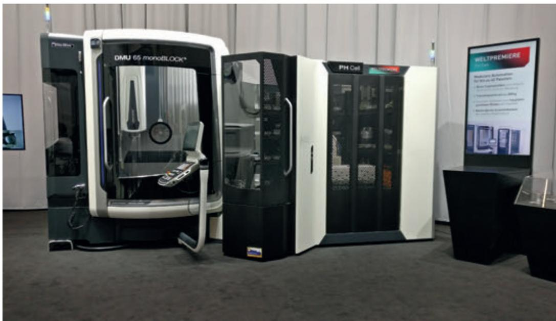
DMG MORI ha presentato il nuovo sistema di pallet PH CELL con un ingombro di 10,7 m<sup>2</sup> su una DMU 65 monoBLOCK.
