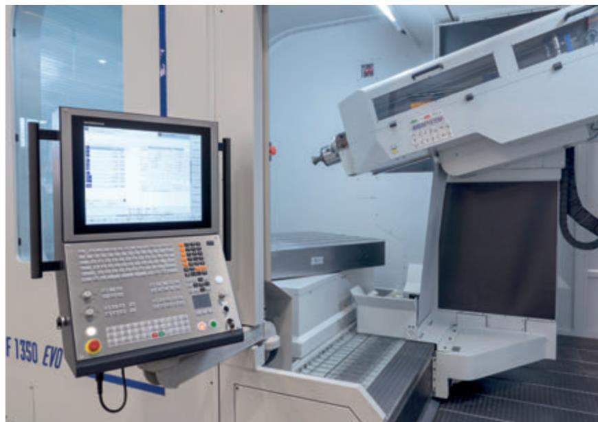
III L'RTCP avanzato del CNC Heidenhain assieme a specifiche funzioni I.M.S.A. permettono lavorazioni sulle quattro facce dello stampo con una singola origine.
