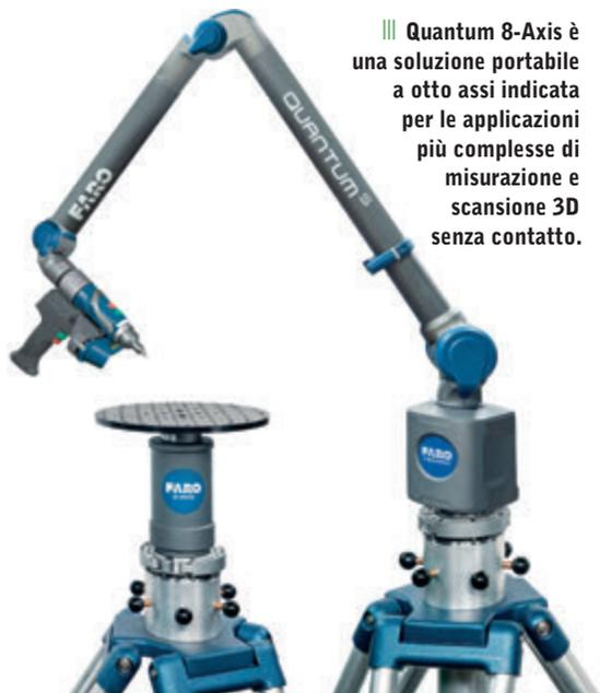
III **Quantum 8-Axis** è una soluzione portatile a otto assi indicata per le applicazioni più complesse di misurazione e scansione 3D senza contatto.
