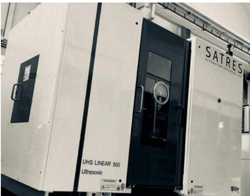
III Con il centro di lavoro UHS Linear 500 è possibile effettuare lavorazioni HSM di fresatura, foratura profonda, rettifica e tornitura (in opzione) su superleghe, materiali ceramici e compositi.
