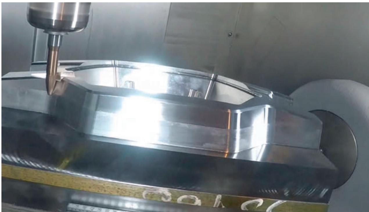
La sgrossatura con la tecnologia Advanced Toolform di WorkNC 2020.1 permette al processo di fresatura di fornire una sgrossatura più accurata.
