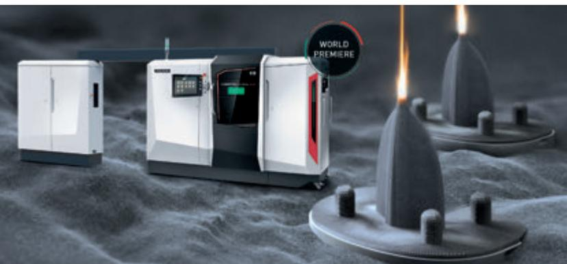
III **LASERTEC 30 DUAL SLM:** due potenti laser da 600 W, il cui campo di scansione copre l'intera area di costruzione, consentono velocità di costruzione fino a 90 cm<sup>3</sup>/h.
