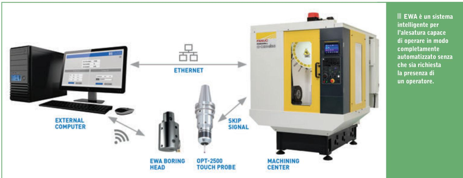
III EWA è un sistema intelligente per l'alesatura capace di operare in modo completamente automatizzato senza che sia richiesta la presenza di un operatore.
