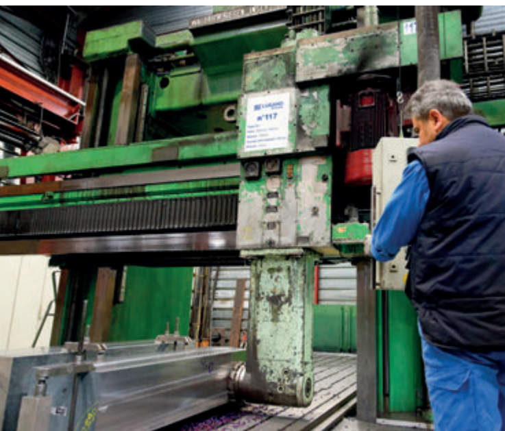
III Fresatrice per la lavorazione di grandi blocchi presso la sede di Groissiat.
