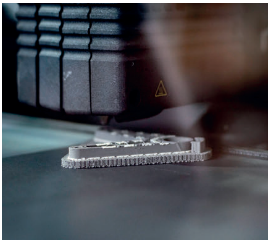
REALIZZAZIONE DI UN PEZZO SU UNA DESKTOP METAL PRESSO IL DIPARTIMENTO DI MECCANICA DEL POLITECNICO DI MILANO.
