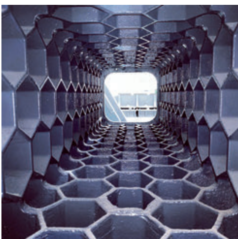
III La struttura delle macchine è in fusione di ghisa a nido d'ape.
