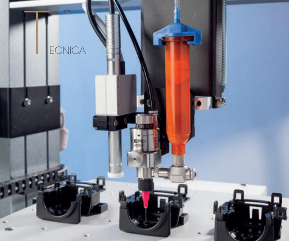
Robot con valvola XQR41 applica lubrificante su componente automotive.
