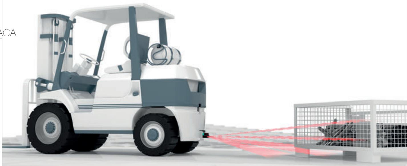
robotica, richiedono che lo scanner multistrato abbia un design particolarmente robusto. Per questo motivo, la custodia del sensore è realizzata in materiale plastico resistente, e l'elettronica nella testa del sensore è costituita da componenti fissi che garantiscono una protezione efficace contro le vibrazioni.
