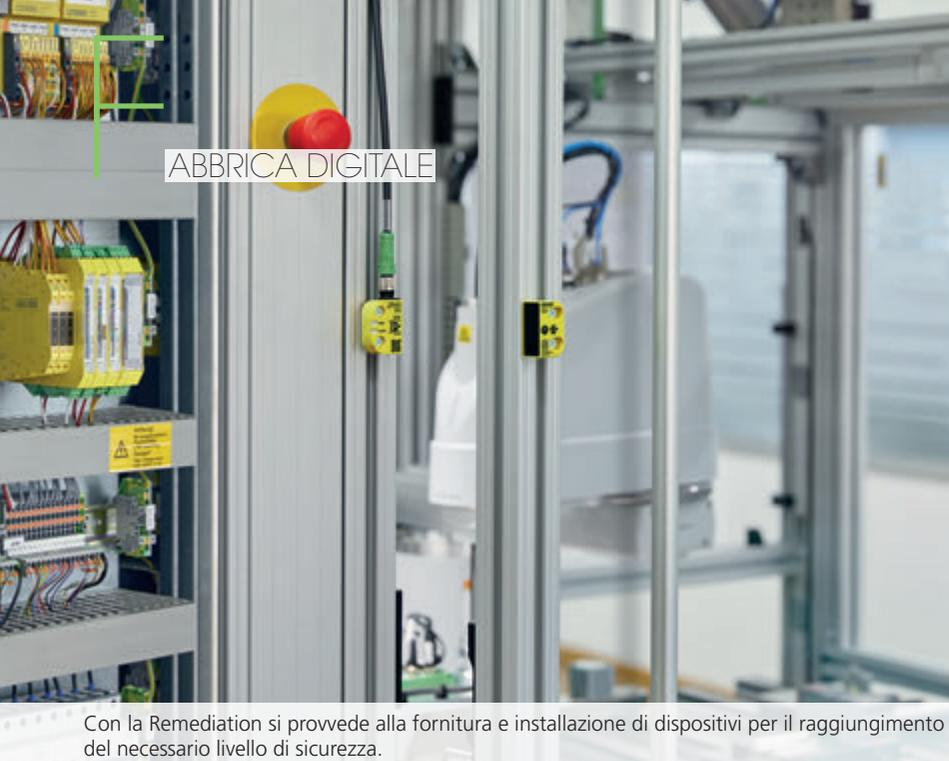
Con la Remediation si provvede alla fornitura e installazione di dispositivi per il raggiungimento del necessario livello di sicurezza.
