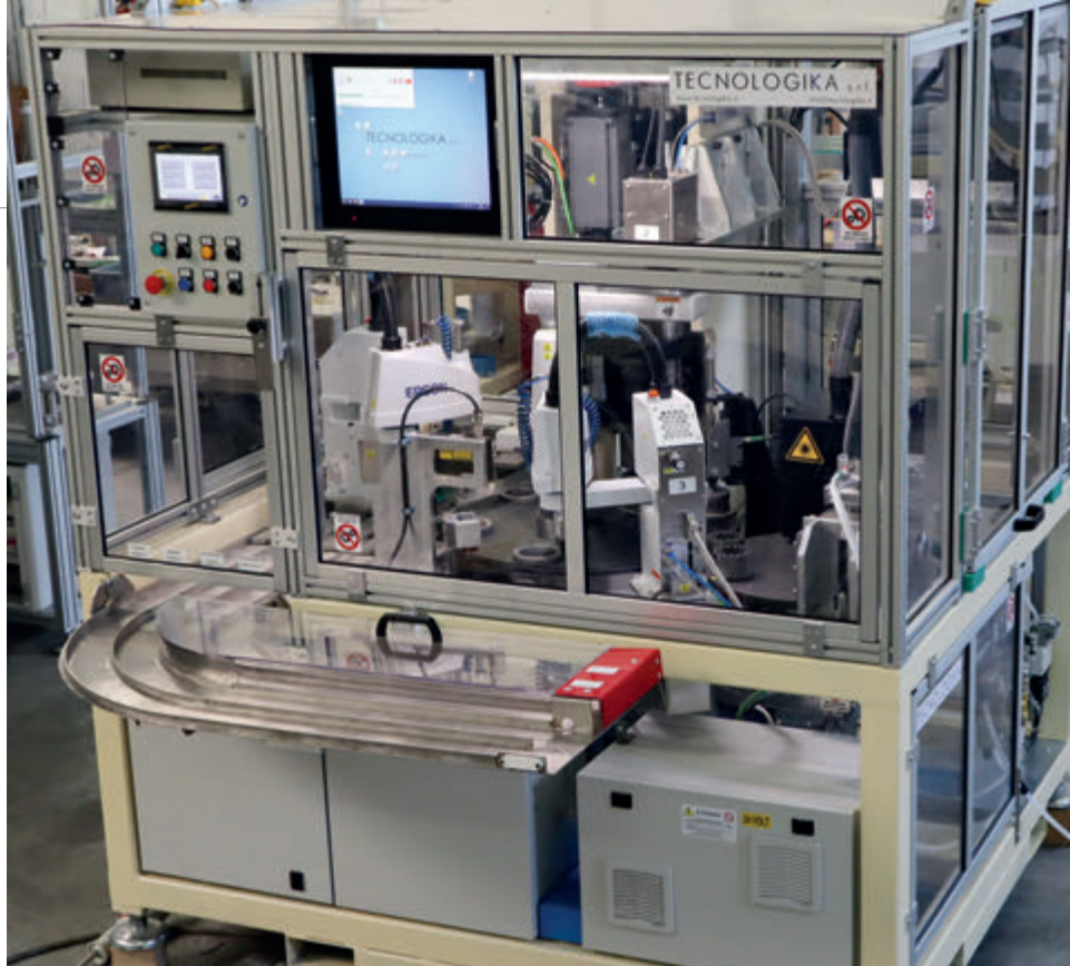
Vista d'insieme della macchina per il collaudo di pacchi lamellari per motori elettrici.
