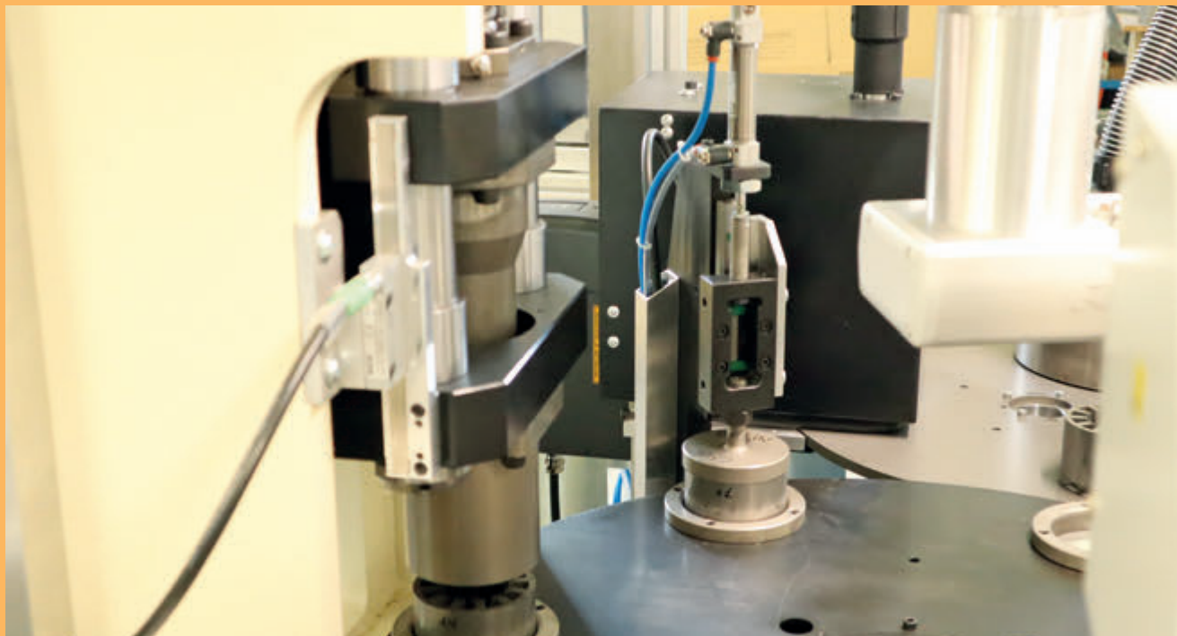
Le stazioni di compressione e calibratura nella tavola rotante principale della macchina.
