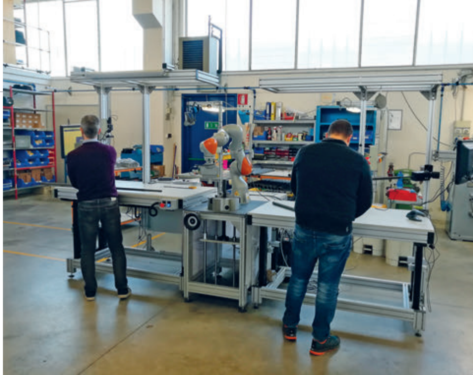
Figura 2. La doppia postazione di lavoro adattiva dedicata all'attività di assemblaggio del sottogruppo di incollaggio dei tubi di carbonio con boccole di alluminio.
