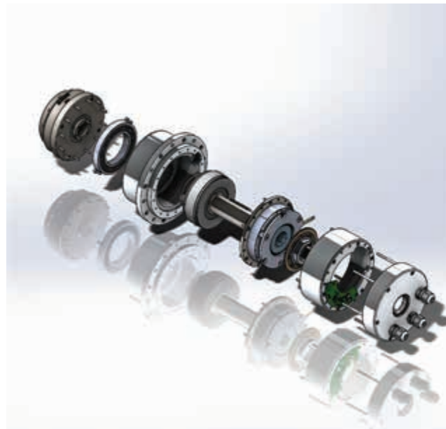
A sinistra, disegno di un giunto robotico a T e, a destra, la sezione trasversale che mostra i diversi componenti del giunto.
