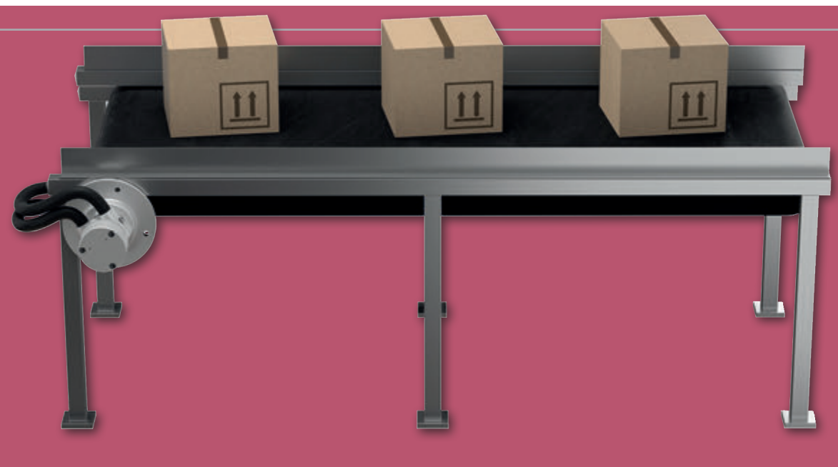
La movimentazione di un nastro trasportatore, un'applicazione tipica dei motori ad aria.
