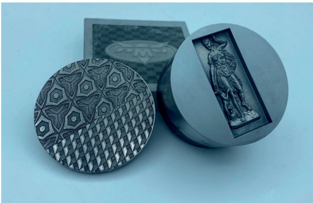
Esempi campioni 3D per stampi e texturing da eseguire tramite engraving laser
