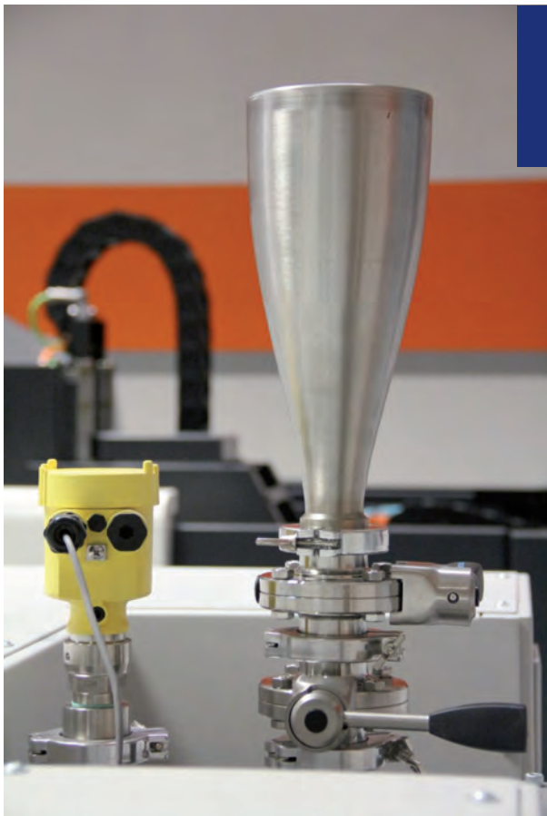
PARTICOLARE DEL SISTEMA A DOPPIA VALVOLA PER IL TRASFERIMENTO DELLE POLVERI.
