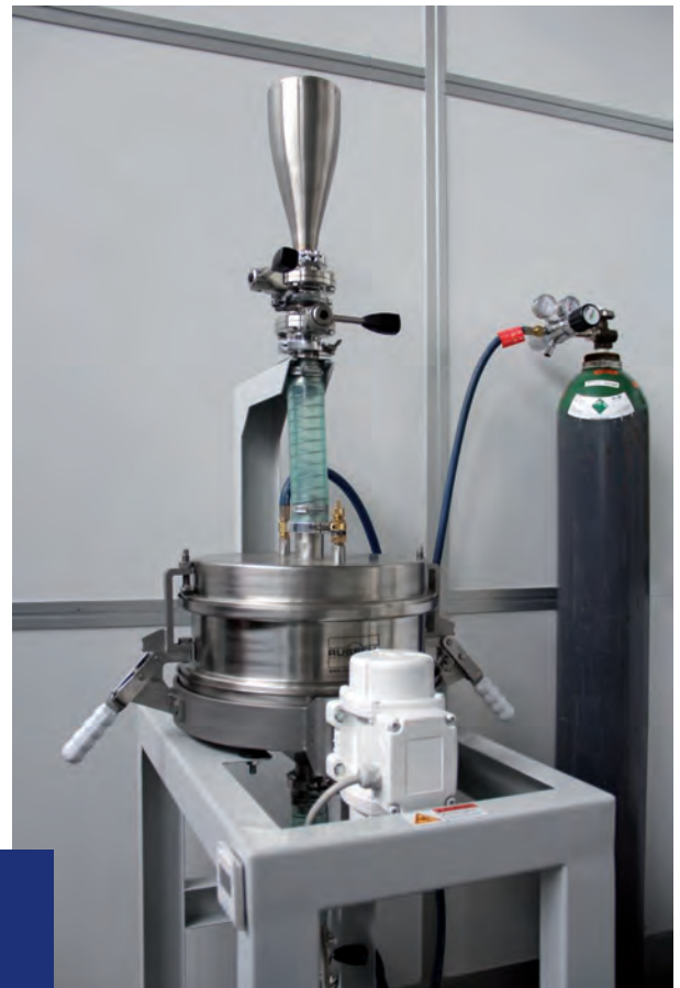
PARTICOLARE DEL SISTEMA DI SETACCIATURA IN ATMOSFERA PROTETTA.
