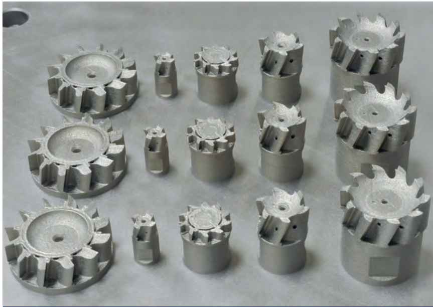
CON LA STAMPA 3D IN METALLO È POSSIBILE PRODURRE IN UN'UNICA OPERAZIONE FRESE AD AVVITAMENTO IN ACCIAIO MARAGING.
