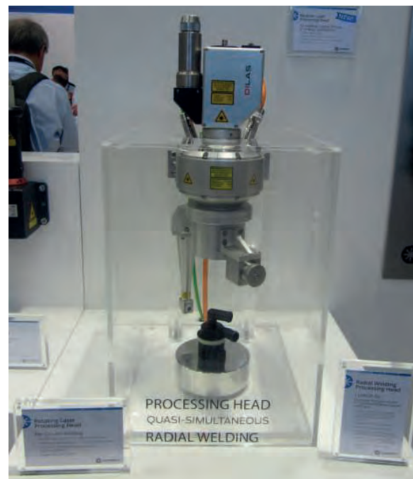
Testa di saldatura Coherent-Dilas per la giunzione di elementi circolari.
