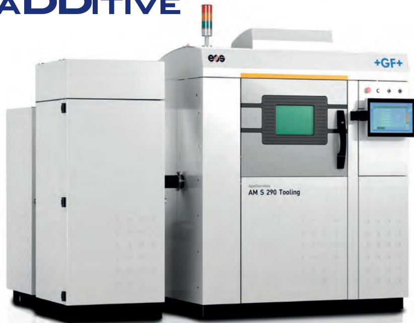
AM S 290 TOOLING È UN IMPIANTO PER PRODUZIONE ADDITIVA A LETTO DI POLVERI.
